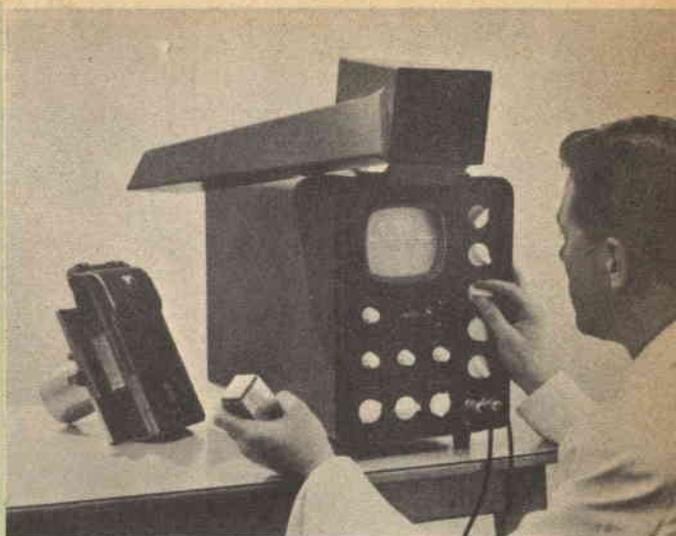
l'apparecchio vengono frazionate da un disco perforato ruotante alla velocità di mille giri al minuto; questa azione di frazionamento interrompe anche la luce emessa da una piccola lampada impiegata per illuminare una cellula fotoelettrica usata come indicatrice di fase. Come conseguenza della rotazione del disco, il rivelatore riceve un segnale pulsante infrarosso ed a sua volta trasmette un segnale a corrente alternata alla seconda unità, cioè ad un amplificatore ad alto guadagno.
