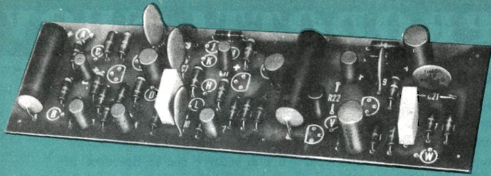
Fig. 8 - Illustrazione del preamplificatore montato, prima dell'installazione dei transistori.
