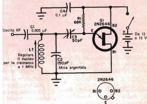
evitare l'effetto della capacità della mano quando si regola C3, è importante che le sue lamine fisse, e non quelle mobili, siano collegate all'emittitore dello UJT.
