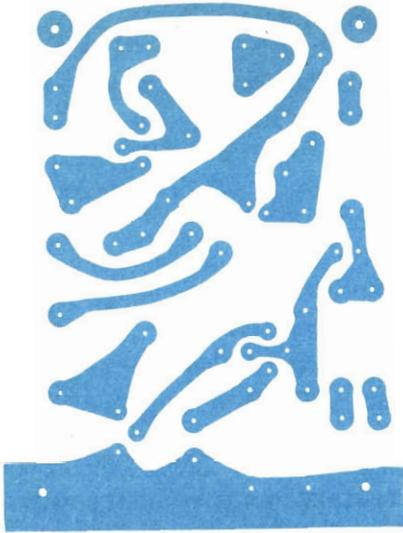
Fig. 2 - Circuito stampato in grandezza naturale per l'amplificatore. I due transistori di potenza ed i componenti ad essi relativi, a causa del calore dissipato, sono montati esternamente.
