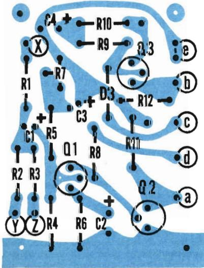
atore d'uscita C5, è montato su un circuito stampato come quello rappresentato in grandezza naturale nella fig. 2. I componenti si montano sul circuito stampato come si vede nella fig. 3. Gli ancoraggi per i collegamenti ai componenti esterni, indicati con lettere nella fig. 3, corrispondono a quelli della fig. 1.
