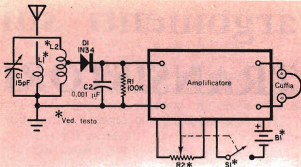
Il circuito del controllo di modulazione è composto da un semplice rivelatore a cristallo e da un modulo amplificatore.
