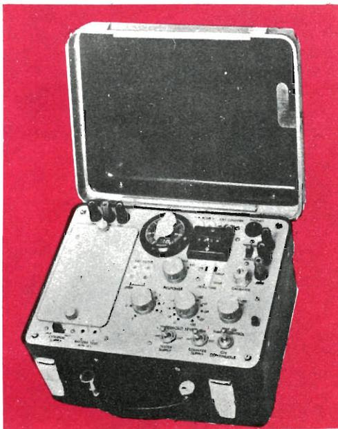
L'alimentazione proviene normalmente da due batterie interne tipo "PP9" (od equivalenti), che permettono una durata di funzionamento continuo di ottanta ore con venti conteggi al minuto. Lo strumento può funzionare mediante batterie situate esternamente, oppure con una normale presa di corrente.
