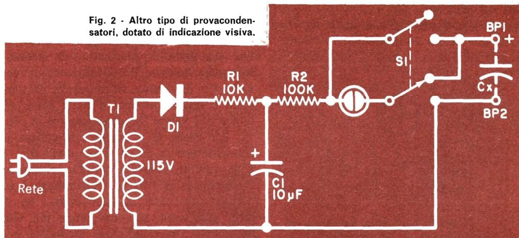
modello. I terminali di prova, BP1 e BP2, sono morsetti da pannello od attacchi di prova equivalenti.
