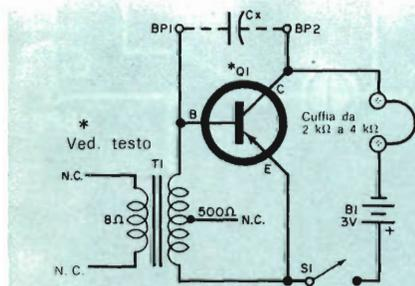
**Fig. 1** - Questo semplice provacondensatori produce un'uscita audio la cui frequenza è determinata dal valore del condensatore in prova.
