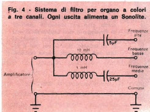
**Fig. 4 - Sistema di filtro per organo a colori a tre canali. Ogni uscita alimenta un Sonolite.**
