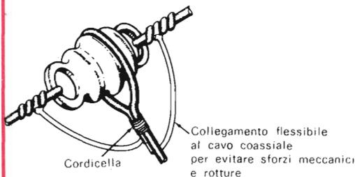
Per evitare che la linea di trasmissione si possa spezzare nei punti di collegamento agli elementi d'antenna, è bene fissarla all'isolatore centrale come è illustrato nel disegno a sinistra. Inserite la linea di trasmissione in una gola dell'isolatore, quindi ripiegate e fissatela ben stretta con una cordicella.
