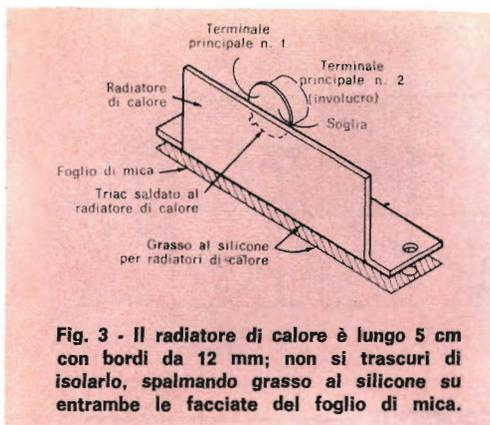
**Fig. 3 - Il radiatore di calore è lungo 5 cm con bordi da 12 mm; non si trascuri di isolarlo, spalmando grasso al silicone su entrambe le facciate del foglio di mica.**
