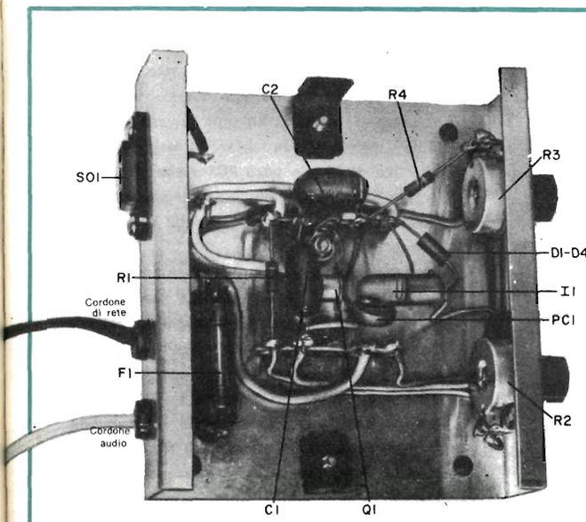
Fig. 2 - Il circuito   montato su due basette d'ancoraggio a cinque capicorda, cio  con capocorda centrale di fissaggio e due capicorda ai due lati. I quattro diodi sono racchiusi in un tubetto. Non si usi mai il telaio metallico come massa comune.
