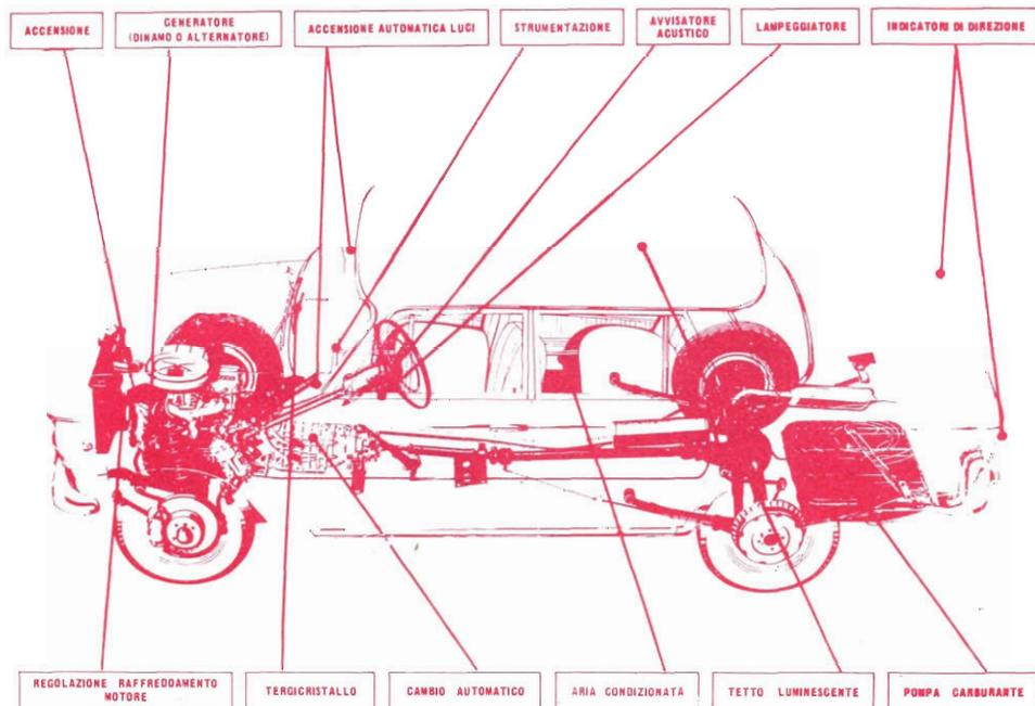
di automobili montano un sistema completamente elettronico di accensione, il quale rende più rapido e sicuro l'avviamento a freddo del motore.
