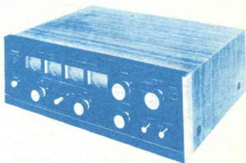
Caratteristica distintiva del decodificatore QS1 della Sansui sono i misuratori di uscita per ogni canale. Questo decodificatore funziona in modo simile al tipo EVX-4 fabbricato dalla ditta Electro-Voice.
