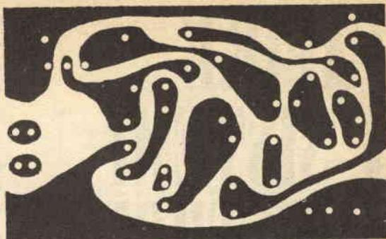
Fig. 2 - Circuito stampato in grandezza naturale e disposizione dei componenti. Si noti che in questo circuito stampato devono essere usati, per ovvie ragioni, trasformatori miniatura.
