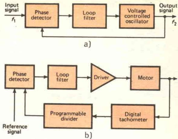
Fig. 12 - Schema a blocchi del circuito fondamentale.
