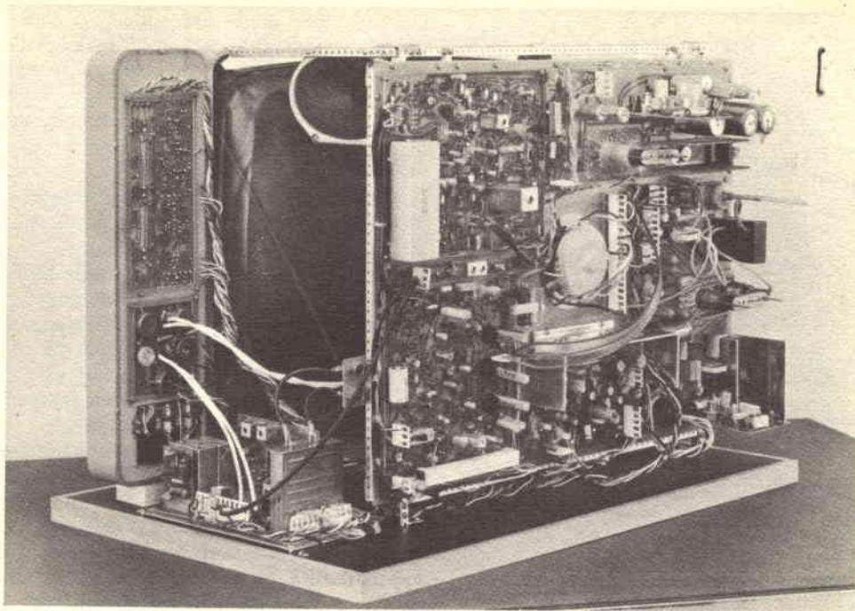
Fig. 3 - Televisore a colori a 110" a stato solido realizzato nei laboratori SGS/ATES.
