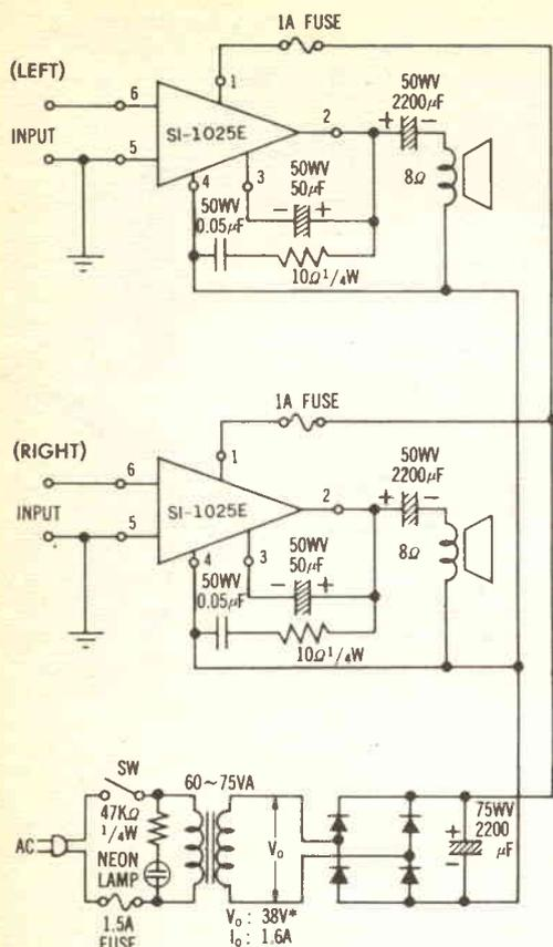
*Fig. 2 - Schema elettrico d'impiego del circuito ibrido Sanken in un amplificatore stereofonico.*
