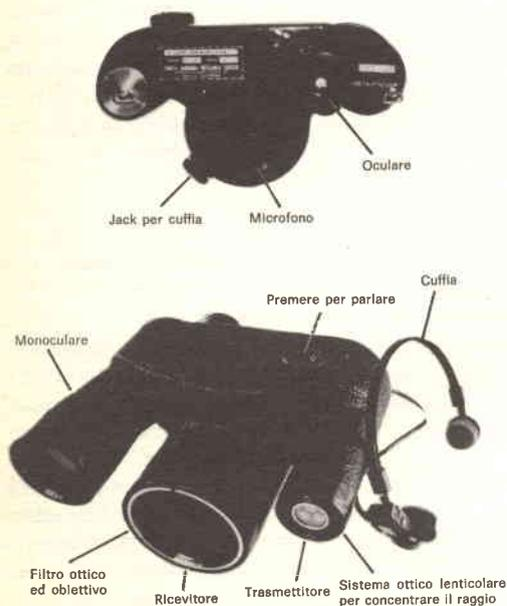
I ricetrasmittitori portatili vengono usati da svariati anni e sono diventati ormai molto comuni. Ora, però, abbiamo un sistema visivo nel quale viene usato l'ultimo ritrovato nel campo dei dispositivi per comunicazione: il laser a stato solido. Questo ricetrasmittitore, che ha l'aspetto di un binocolo con tre obiettivi, pesa solo 1.350 grammi ed è stato costruito dalla Santa Barbara Research Center americana, una succursale della Hughes Aircraft Co.
