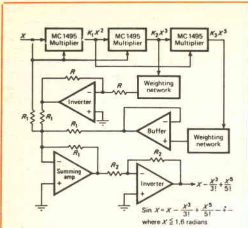
Fig. 9 - Funzioni sinusoidali ottenute con i moltiplicatori.
