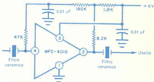
Fig. 10 - Il circuito integrato usato in questo amplificatore FI è di tipo economico e fornisce un guadagno di 70 dB a 455 kHz.
