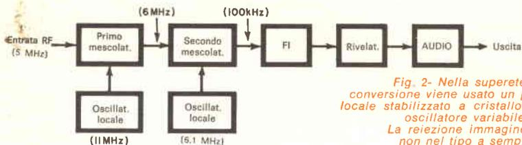
**Fig. 2 -** Nella supereterodina a doppia conversione viene usato un primo oscillatore locale stabilizzato a cristallo ed un secondo oscillatore variabile per la sintonia. La reiezione immagine è migliore che non nel tipo a semplice conversione.
