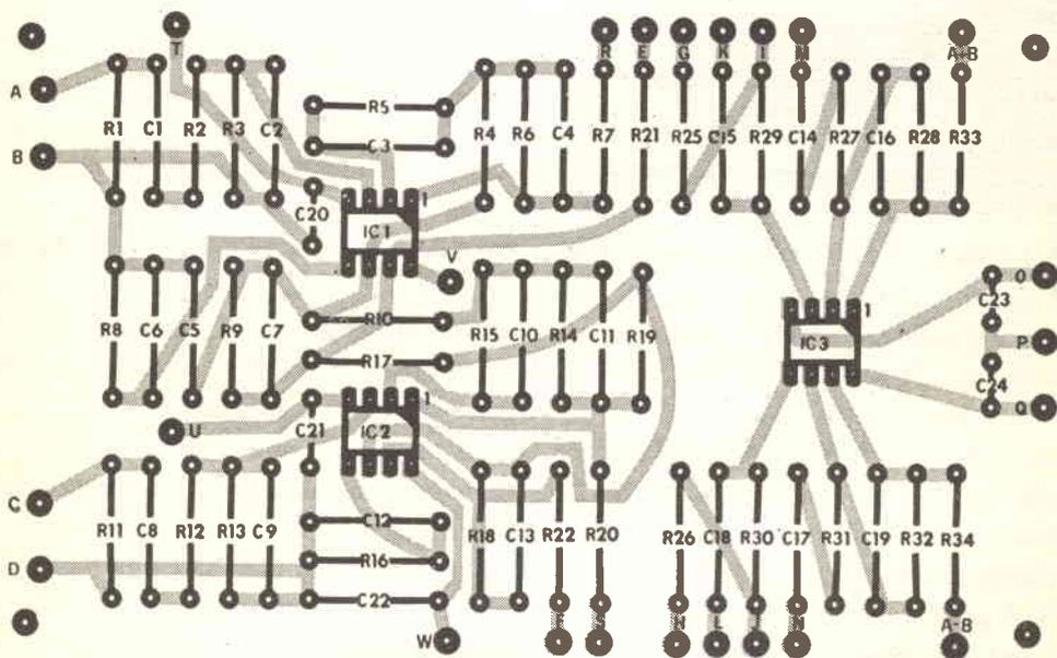
*Fig. 2 - Circuito stampato in grandezza naturale e disposizione dei componenti del sintetizzatore. Si usi un saldatore di bassa potenza e filo di stagno sottile.*
