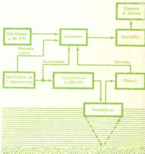
**MONTAGGIO FACILE** - Usando il manuale di montaggio e d'uso fornito dalla Heathkit, il tempo necessario per montare il suddetto ecometro è di circa otto ore. Lo strumento in questione impiega sette circuiti integrati, per i quali vengono forniti i relativi zoccoli; viene così eliminata qualsiasi possibilità di danno termico per i circuiti integrati durante le operazioni di saldatura. Le parti metalliche, la scatola di plastica ed i componenti elettronici sono tutti di prima qualità.
