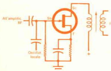
**Fig. 5 -** Questo circuito mostra come un FET a giunzione può essere usato come mescolatore. L'isolamento è minore che impiegando un MOSFET a doppia soglia.
