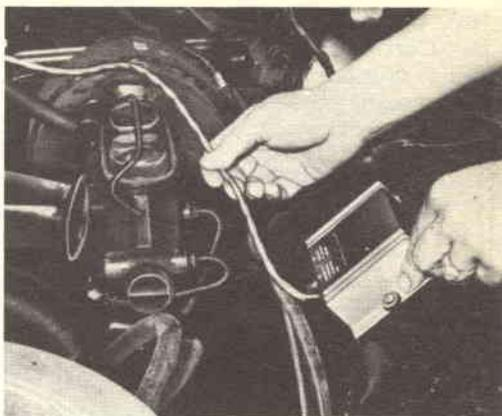
*Montate il prolungatore del tempo di pausa in un punto relativamente fresco (nel caso illustrato, sulla lamiera interna del parafango), usando adatti accessori e gommini sul radiatore di calore per assorbire gli urti e le vibrazioni. Per i due cavetti di collegamento, si possono usare gli stessi accessori normali per la parte elettrica del motore.*
