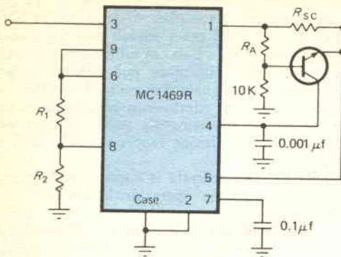
Fig. 5 - Il circuito di fold back per la limitazione di corrente.
