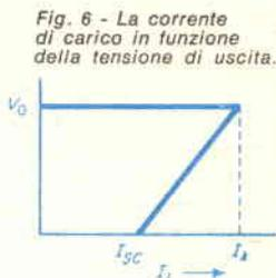
Fig. 6 - La corrente di carico in funzione della tensione di uscita.
