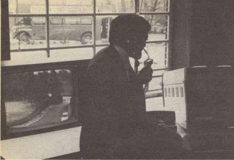
*Fig. 1 - Il sistema automatico di localizzazione e controllo degli autobus adottato dalla LT viene dimostrato nei laboratori di ricerca della ditta costruttrice. Tale sistema localizza continuamente ogni veicolo in una rete di trasporti e presenta le informazioni su uno schermo televisivo.*
