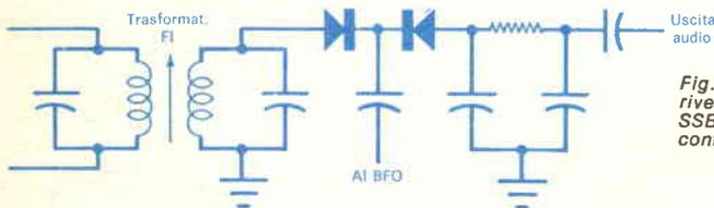
Fig. 11 - Questo semplice rivelatore a prodotto per CW o SSB impiega due diodi contrapposti.
