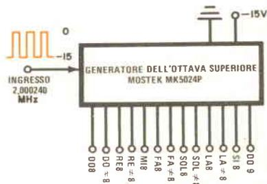
*Fig. 3 - Generatore per l'ottava superiore in circuito integrato singolo. L'aggiunta di divisori binari sulle uscite od all'ingresso permette di generare le note delle altre ottave.*
