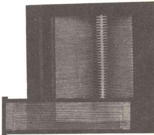
Il primo sistema di altoparlanti prodotto dalla ESS su progetto di Heil, è il modello amt-1; si tratta in realtà di un complesso ibrido, che impiega un tweeter realizzato secondo l'idea di Heil ed un woofer a cono di tipo tradizionale, e questo perché le strutture magnetiche per una membrana Heil con dimensioni degne di un woofer sarebbero troppo massicce e per nulla pratiche.
