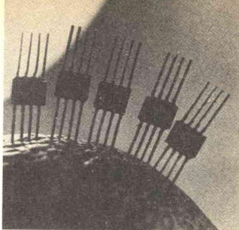
Fig. 1 - Esempi del fotoamplificatore integrato TPV 63, prodotto recentemente dalla Siemens.
