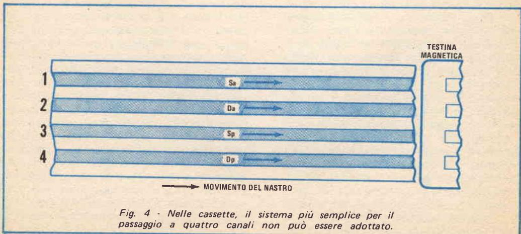
*Fig. 4 - Nelle cassette, il sistema più semplice per il passaggio a quattro canali non può essere adottato.*
