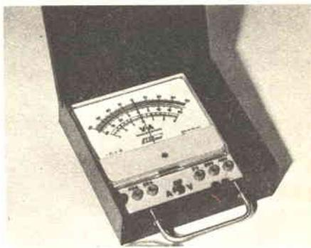
strumento tipico a cui l'elettrauto ricorre ogniqualvolta si debba ricercare un guasto e controllare i circuiti elettrici di un autoveicolo.
