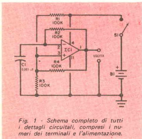
Fig. 1 - Schema completo di tutti i dettagli circuitali, compresi i numeri dei terminali e l'alimentazione.
