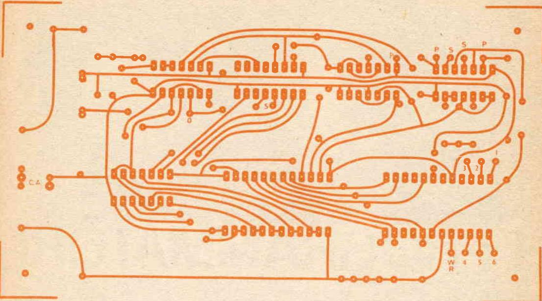
Fig. 5 - Anche se lo Scowriter può essere montato su una basetta perforata, è consigliabile fare uso di un circuito stampato, del tipo di quello rappresentato in alto; nella foto sotto, è visibile la disposizione dei componenti sul predetto circuito.
