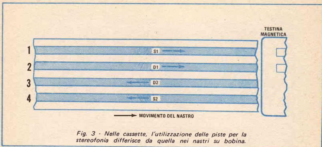
*Fig. 3 - Nelle cassette, l'utilizzazione delle piste per la stereofonia differisce da quella nei nastri su bobina.*
