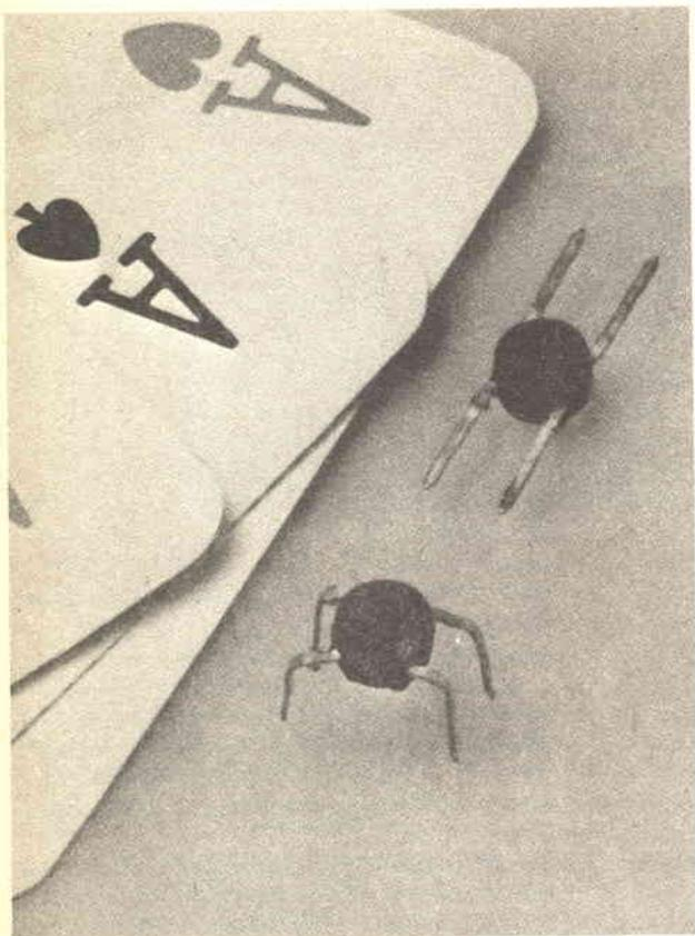
*Fig. 4 - Nuovi transistori MOS racchiusi in contenitore plastico prodotti dalla General Instruments, e reperibili sul mercato ad un prezzo non elevato.*
