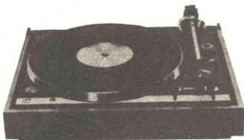
Il giradischi automatico senza cambiadischi Mod. 701 della Dual è dotato di un sistema a trazione diretta con regolazione automatica. Il suo motore, che gira ad una velocità di 33-1/3 (o, a scelta, 45) giri al minuto, elimina la necessità di rotelle o cinghie di trasmissione; grazie alla bassissima velocità di rotazione, il rumore di fondo risulta minimo e con frequenza al di sotto del campo di udibilità.
