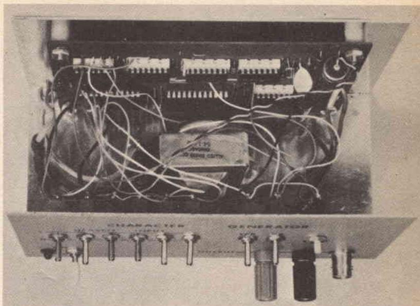
zione all'orientamento dei circuiti integrati basandosi sull'intaccatura di riferimento e si rispettino le polarità dei condensatori elettrolitici. E' pure consigliabile l'uso di zoccoli per i circuiti integrati. Anche se questi sono protetti contro le cariche statiche, è buona pratica maneggiarli il meno possibile ed inserirli per ultimi nel circuito.
