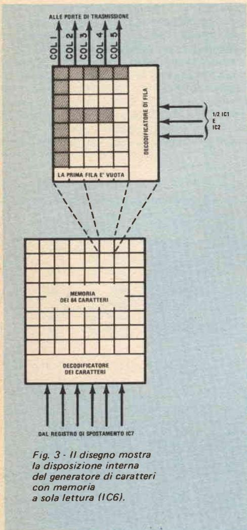
Fig. 3 - Il disegno mostra la disposizione interna del generatore di caratteri con memoria a sola lettura (IC6).
