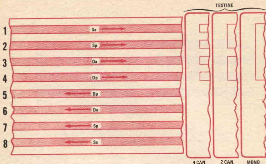
*Fig. 5 - Nelle cassette, una ulteriore suddivisione della larghezza delle piste, che raggiungono così il numero di otto, permette di mantenere la compatibilità in mono, stereo e quadrifonia, e di non abbreviare la durata della registrazione.*
