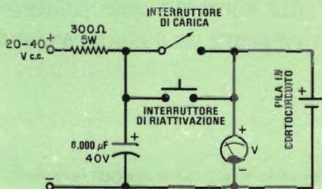
te. Questo effetto a valanga continua fino a che la pila è completamente scarica, anche se le altre pile continuano a forzare il flusso della corrente. Il risultato inevitabile è che la pila debole comincia a caricarsi al rovescio, cosa che alla fine provoca un cortocircuito interno.
