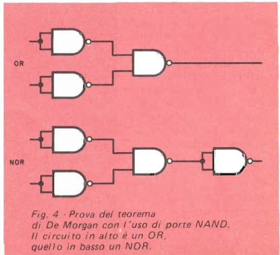
circuiti logici, nel senso che combinando solo porte NAND o NOR si può realizzare qualsiasi funzione logica. La *fig. 4*, per esempio, mostra come con sole porte NAND si possano ottenere le funzioni OR e NOR. Si noti che le porte NAND sono usate come invertitori per convertire agli ingressi la logica da positiva a negativa.
