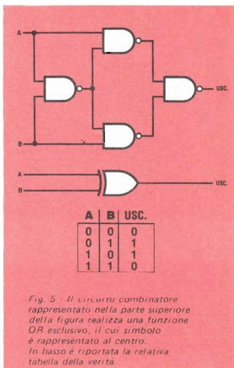
*Fig. 5 - Il circuito combinatorio rappresentato nella parte superiore della figura realizza una funzione OR esclusivo, il cui simbolo è rappresentato al centro. In basso è riportata la relativa tabella della verità.*
