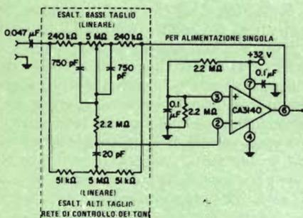
Fig. 2 - In questo circuito Baxandall per il controllo dei toni vengono usate unità BIMOS.
