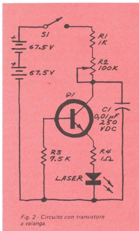
Fig. 2 - Circuito con transistor a valanga.
