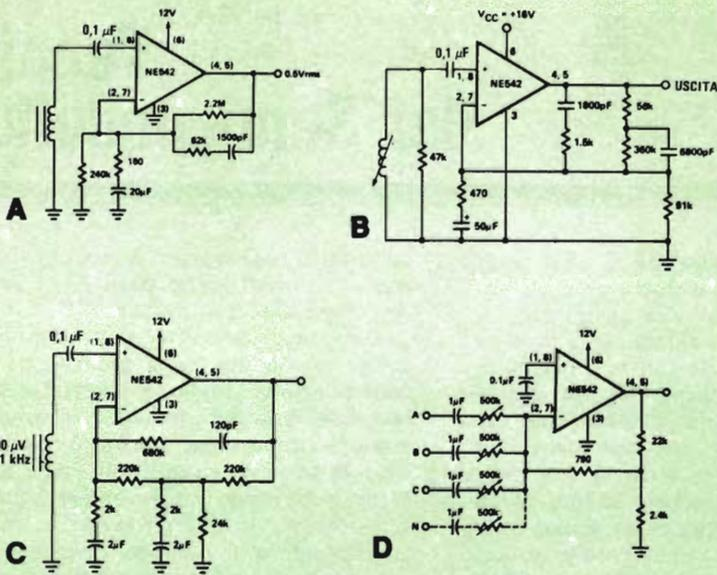
Fig. 1 - Circuiti preamplificatori audio: (a) riproduzione nastro; (b) fono equalizzazione RIAA; (c) preamplificatore per nastro con equalizzazione NAB; (d) mescolatore.
