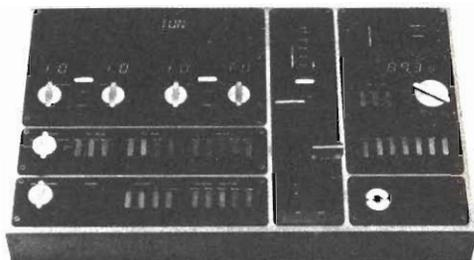
*Nel preamplificatore-centro di controllo RCS-X-1000 della Setton è incorporato un sintonizzatore a sintesi di frequenza e con lettura numerica.*
