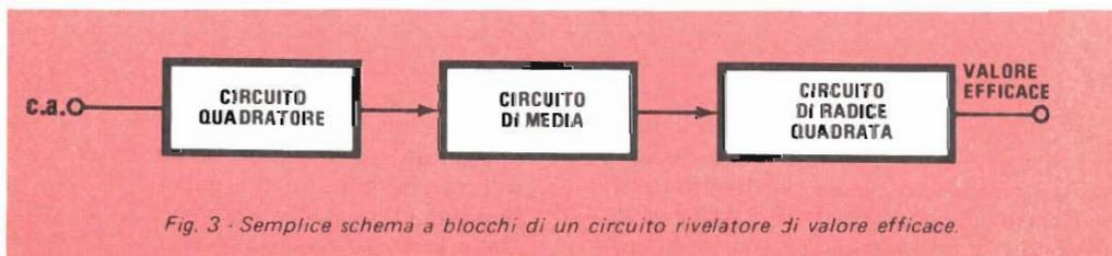
*Fig. 3 - Semplice schema a blocchi di un circuito rivelatore di valore efficace.*
