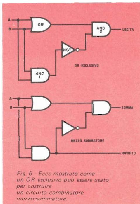
*Fig. 6 - Ecco mostrato come un OR esclusivo può essere usato per costruire un circuito combinatorio mezzo-sommatore.*
