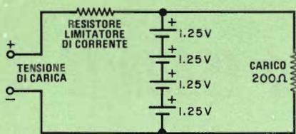
Fig. 1 - Schema di un tipico alimentatore per un piccolo carico con pile al Ni-Cd.
