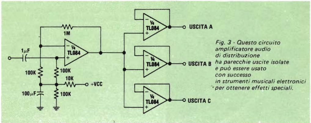
*Fig. 3 - Questo circuito amplificatore audio di distribuzione ha parecchie uscite isolate e può essere usato con successo in strumenti musicali elettronici per ottenere effetti speciali.*
