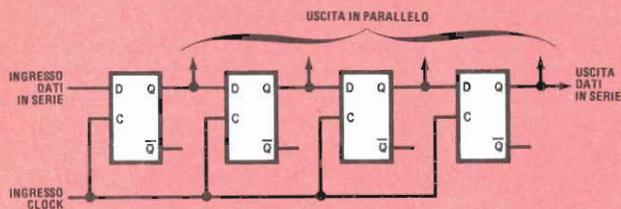
Fig. 15 - Questo registro a scorrimento, costituito con flip-flop di tipo D, accetta i dati un bit alla volta ed ha sia un'uscita in serie, sia uscite in parallelo da ogni flip-flop.
