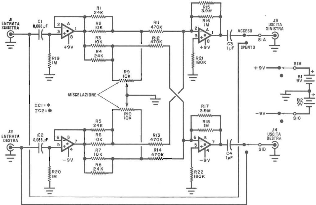
Fig. 1 - Schema del miscelatore stereo.
