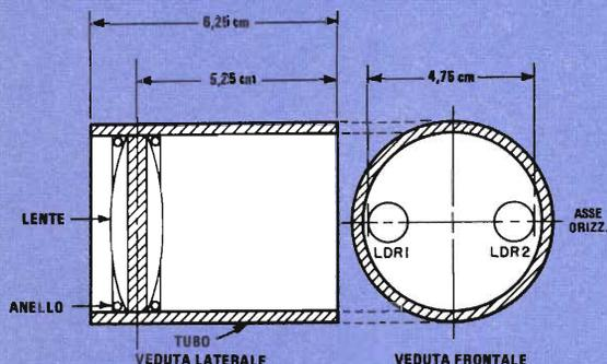
Fig. 2 - Dimensioni da seguire per tagliare il tubo di plastica entro cui inserire la lente.
