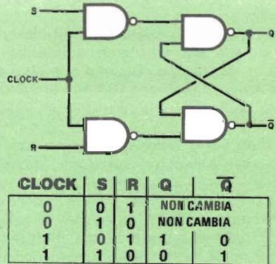
Fig. 12 - Un flip-flop RS sincronizzato è un circuito sequenziale avente la tabella della verità mostrata in questa stessa figura.
