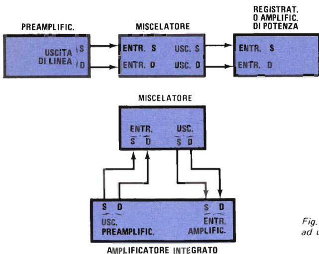
Fig. 3 - Collegamenti del miscelatore ad un sistema stereo.
