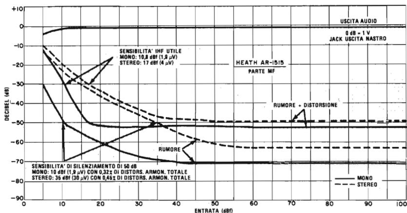
Curve di rumore e sensibilità della parte MF del ricevitore.
