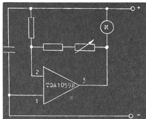
Fig. 7 - Schema di impiego del TDA 1059B Philips.
