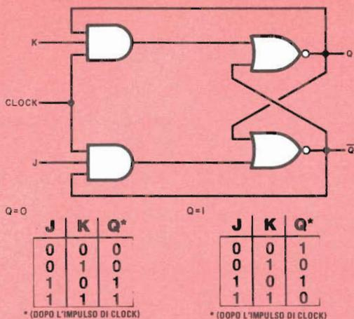
Fig. 14 - Il flip-flop JK è un flip-flop RS sincronizzato al quale può però essere applicato un 1 logico su entrambi gli ingressi contemporaneamente. Nella figura ne è mostrata una versione realizzata con porte NOR insieme con le tabelle della verità che caratterizzano il funzionamento del circuito nel caso in cui  $Q = 0$  e nel caso in cui  $Q = 1$ .
