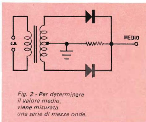
*Fig. 2 - Per determinare il valore medio, viene misurata una serie di mezza onde.*
