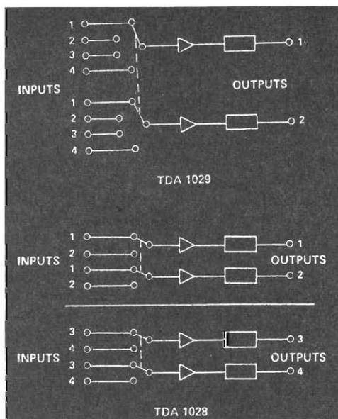
Fig. 6 - Schemi di utilizzazione dei nuovi circuiti integrati bipolari TDA 1028 e TDA 1029 della Philips.
