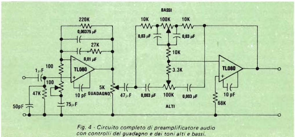
*Fig. 4 - Circuito completo di preamplificatore audio con controlli del guadagno e dei toni alti e bassi.*
