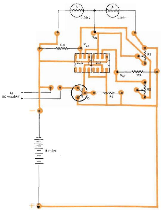
Fig. 4 - Disegno e piano di foratura del circuito stampato e disposizione dei componenti.
