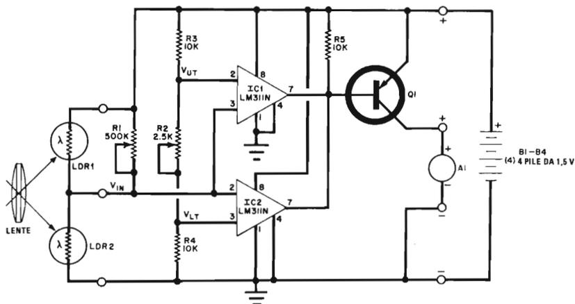
Fig. 1 - La luce che colpisce le fotocellule determina le entrate agli amplificatori operazionali comparatori.
