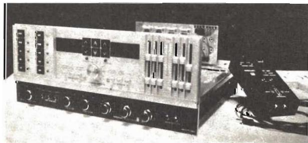
*Il preamplificatore DL-2 della Crown ha un "modulo di commutazione" con tutti i controlli e un modulo preamplificatore fono (a destra) da sistemare vicino ai giradischi.*
