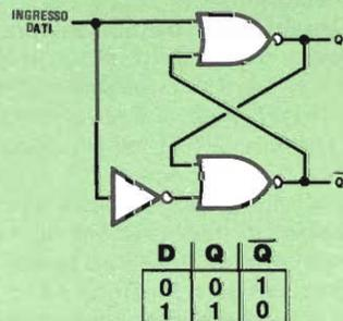
Fig. 13 - Un flip-flop D (o flip-flop Dati) è costruito aggiungendo un invertitore all'ingresso di un flip-flop.
