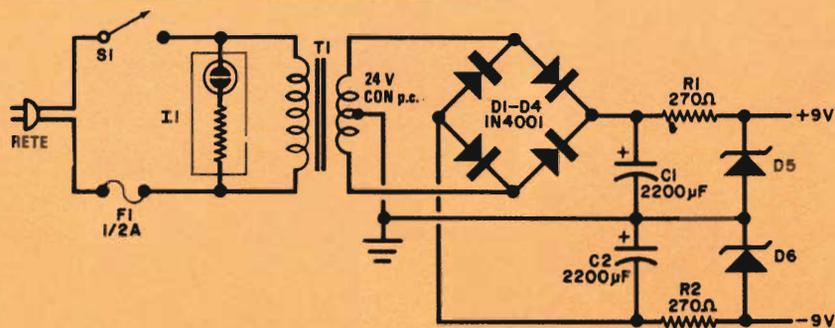
Fig. 2 - L'alimentatore a rete è stabilizzato con diodi zener.
