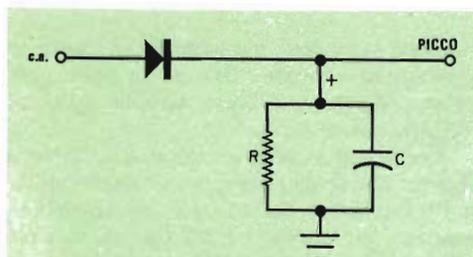
*Fig. 1 - Un semplice circuito RC e un diodo vengono usati per determinare il potenziale di picco.*
