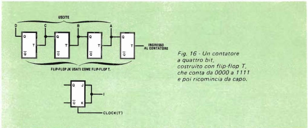
Fig. 16 - Un contatore a quattro bit, costruito con flip-flop T, che conta da 0000 a 1111 e poi ricomincia da capo.
