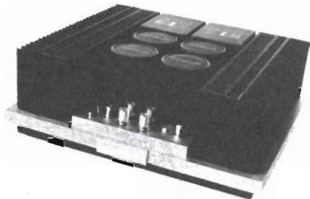
*La potenza d'uscita specificata dell'amplificatore di potenza Pioneer M-22 è di 30 W per canale.*
