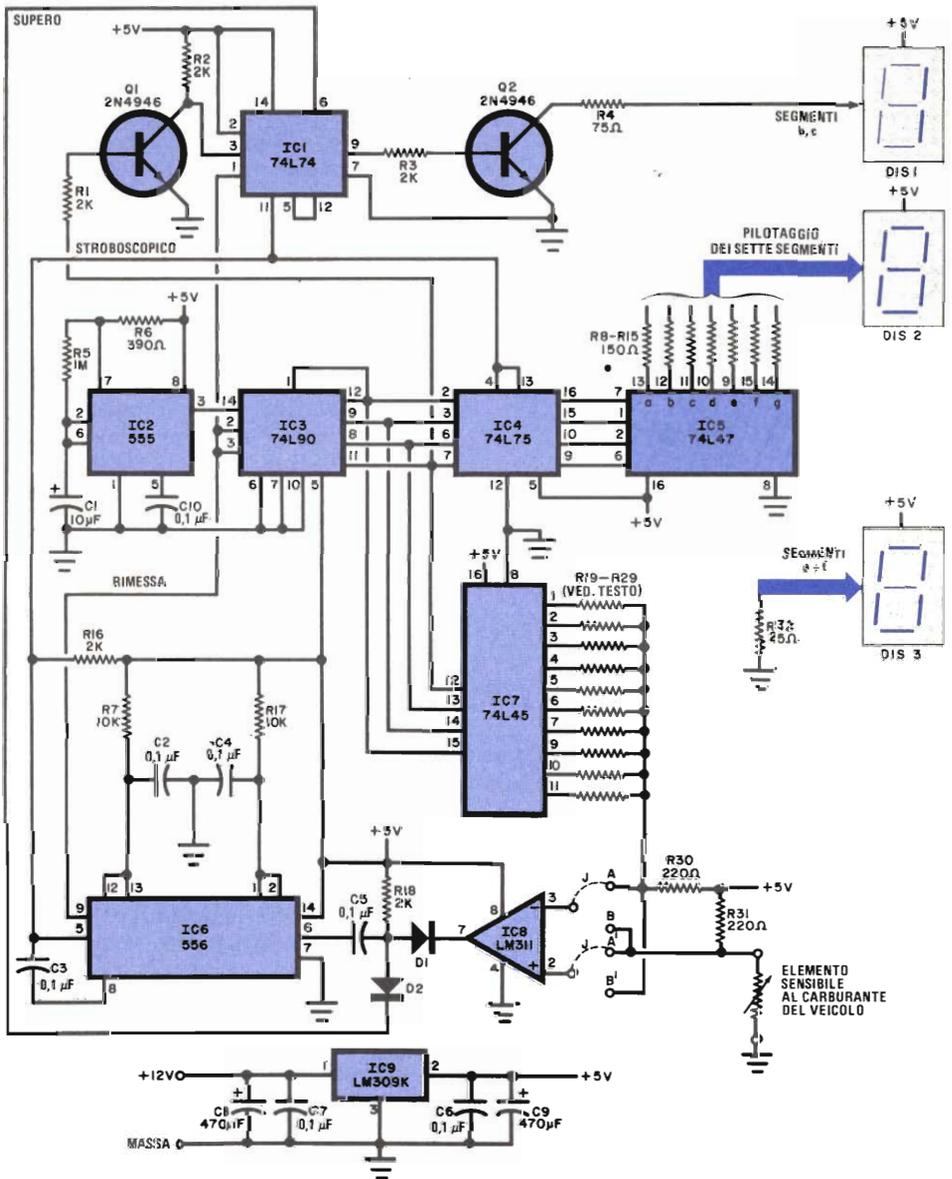
Fig. 2 - Schema completo del misuratore numerico di carburante.
