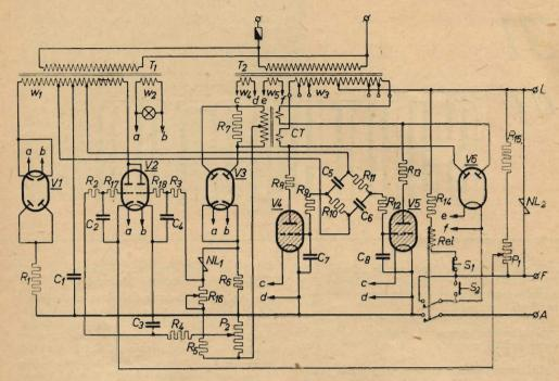
Fig. 5 - Circuito completo del sistema di controllo semplificato che rac chiude in se il circuito di controllo di fig. 3, il circuito limitatore di fig. 4 e la compensazione dell'IR-drop. Tutti i valori pratici sono elencati qui appresso.
