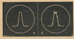
Fig. 4 - La curva di sinistra rappresenta una normale curva di selettività, mentre che la curva di destra denota la presenza di oscillazioni parassite rell'amplificatore di MF.
