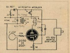
Fig. 2 - Ricevitore che utilizza una 2050 con un'antenna monospira. Esso aziona un apriponte elettrico.
