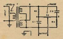
Fig. 2 - Circuito elettrico del subtractor-
