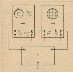
Fig. 2 - Come si esegue in pratica il collegamento fra il wobbulatore, il ricevitore e l'oscillografo.
