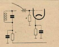
Fig. 3 - Il wobbulatore verrà collegato alla griglia della convertitrice cne verrà staccata dal gruppo e collegata a massa attraverso una resistenza da 50 k-chm.
