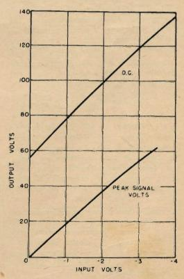
Fig. 5 - Curve della sezione amplificatrice video della 28D7.
