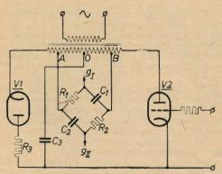
Fig. 1 - Circuito semplificato, base del controllo, col quale si applica alla griglia una tensione sfasata di 90° rispetto a quella di placca, con una tensione CC sovrapposta.
