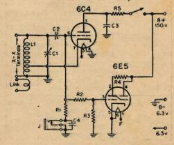
L'interruttore posto sulla tensione anodica verrà usato anche ogniqualvolta si cambierà la induttanza.
