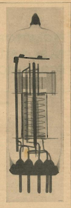
La Philips ha adottato il controllo mediante i raggi X della propria produzione di valvole per scoprire qualunque imperfezione strutturale. Ecco una miniatura vista ai raggi X.
