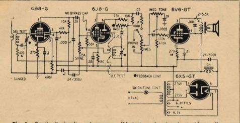
Fig. 2 - Questo il circuito cui pervenne l'Autore, e che si può considerare il più semplice ricevitore del genere.
