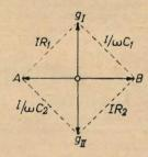
Fig. 2 - Diagramma vettoriale del ponte ai sfasamento contenuto nel circuito della fig. 1. 1 punti gl e gll sono collegati alle griglie dei thyratrons.
