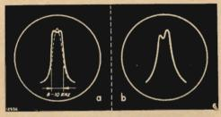
Fig. 5 In (a) si ha una curva di selettività ideale, mentre in (h) si ha una curva dissimetrica che denota un accordo incorretto degli stadi di MF.
