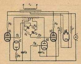
Fig. 3 Ecco come il circuito di controllo della fig. 1 va inscrito nel circuito rettificatore. L'insieme costituisce il circuito regolatore della velocità.
