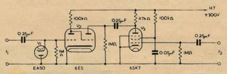
Gircuito elettrico del comparatore di frequenza. Quest'apparecchio sostituisce l'uso dell'oscillografo e permette di apprezzare variazioni di 1/5 di periodo.
