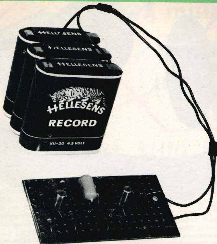
Fig. 3 - Realizzazione pratica su pannello stampato del circuito Schmitt-trigger a transistor.
