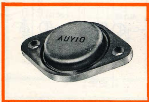
Fig. 2 - Transistor al germanio per alta frequenza AUY 10.
