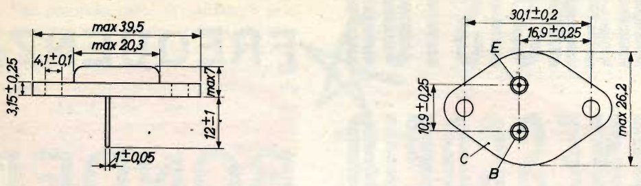
Fig. 3 - Dimensioni d'ingombro del transistor AUY 10.
