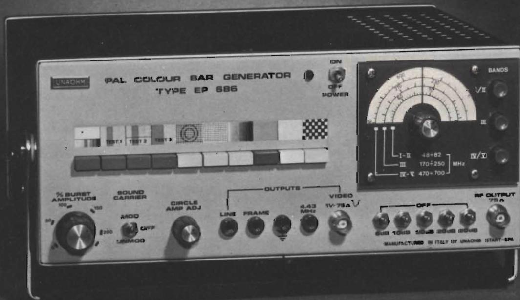
Fornisce segnali TV in bianco e nero ed a colori con prestabilite figure geometriche particolarmente studiate per la messa a punto di un televisore senza dover ricorrere ad altri strumenti.
