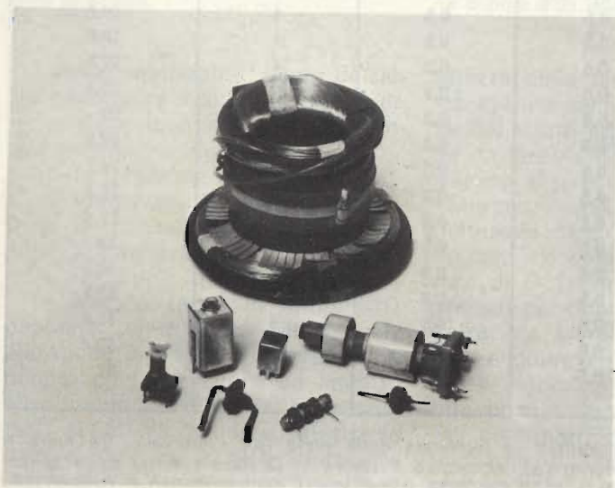
Fig. 1 - Le sole bobine che è possibile trovare in commercio già tutte fatte, sono quelle di Media Frequenza tarate a 455 kHz, le bobine di linearità per TV, le bobine di deflessione, e poche altre. In pratica, lo sperimentatore che ne voglia una per un ben determinato impiego, deve costruirselo da sé.
