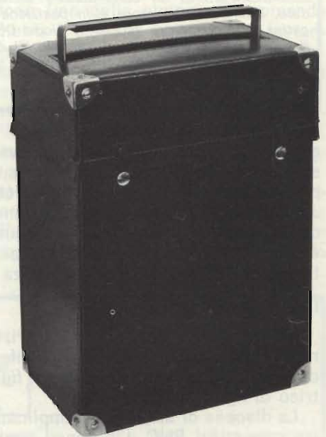
Fig. 1 - Ecco come appare l'EP 736 chiuso nella apposita borsa di trasporto. Le sue dimensioni sono di cm. 50x35x25. Il peso è di circa 5 kg. senza batterie
