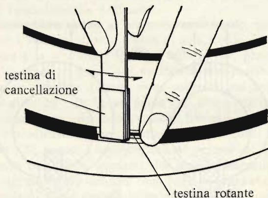
Fig. 7 - La pulizia della testina video (la punta che spunta fuori di tamburo). Con la parte spugnosa del pulitore imbevuta di disgrassante, si muove il pulitore orizzontalmente mantenendo ferma la base della testina con la punta del dito.
