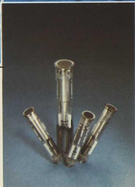
Fig. 2 - Newvicon XQ1274 da 2/3" (ultimo a destra). È lungo 108 mm. Lo strato fotoconduttore è formato da tellururo di cadmio e zinco. La deflessione e la focalizzazione sono magnetiche.
