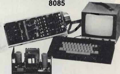
L'hardware standard MK-TPA è presentato in moduli, o schede, formato Olivetti ed è caratterizzato da un progetto originale ed autonomo; tali moduli vengono di volta in volta utilizzati secondo opportune configurazioni e specializzati nel software per la singola applicazione.
