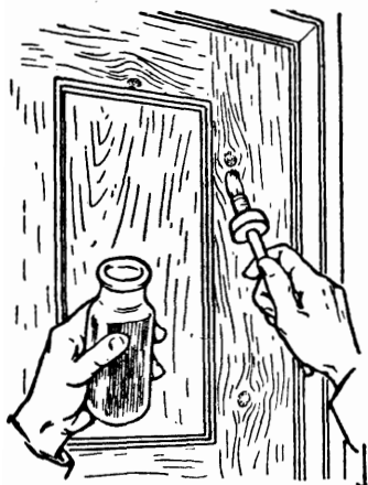
Fig. 15 - Sul legno nuovo tutti i nodi vanno ricoperti con lo speciale liquido per i nodi o con gommalacca prima dell'applicazione della mano di fondo. Senza questa precauzione, la finitura non varrebbe a nasconderli.
