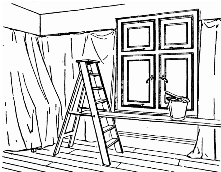
Fig. 27 - Quando si debba imbiancare il soffitto di una stanza è conveniente allontanare tutti i mobili e ricoprire le pareti, se sono già state imbiancate o sono ancora in buone condizioni, con teli fatti incollando l'uno all'altro vecchi giornali.
