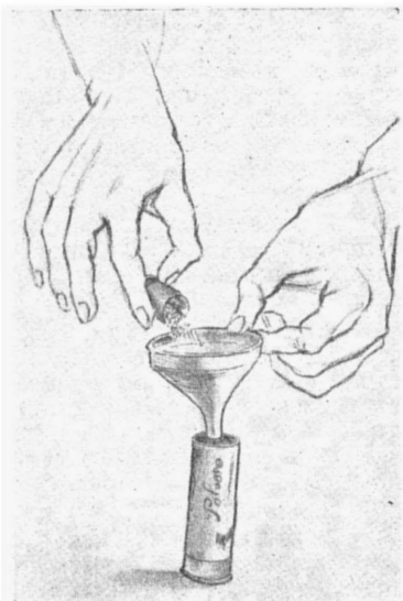
Fig. 5. - Un piccolo imbuto, possibilmente di plastica, serve per versare la polvere dal misurino nella cartuccia. Farne a meno significa inevitabilmente far finire un po' della carica già misurata sul tavolo sul quale si lavora, ottenendo così cariche troppo deboli. Inoltre, per quanto le polveri non diano luogo ad esplosioni quando non sono compresse, non è certo gradevole averne grani sparsi per la casa, perché sono infiammabilissime. L'imbuto, che può essere acquistato per poche lire, elimina ogni difficoltà in proposito e serve anche per il piombo.
