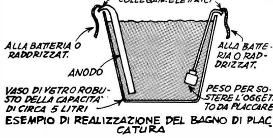
sario che vi aggiungete un poco di acido solforico; non è invece necessario aggiungere del solfato di rame, dato che il rame che va a depositarsi sull'oggetto, viene rimpiazzato gradualmente dalla dissoluzione di quello che costituisce l'anodo.
