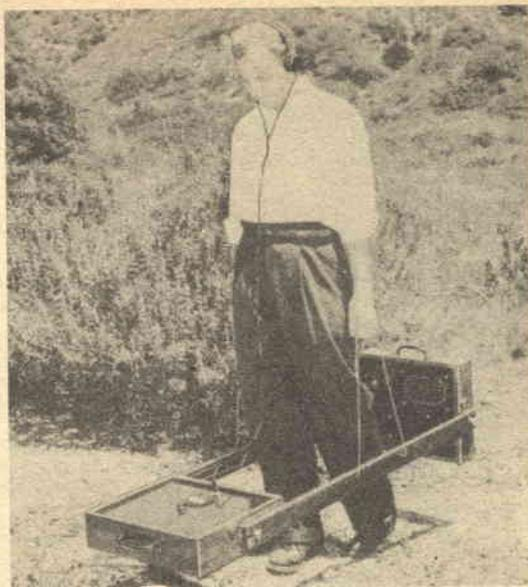
Altre due versioni del cercametri a trasmettitore, ricevitore
