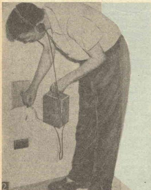
Utilizzazione tipica del cercametalli, in casa per seguire una conduttura elettrica o di gas o di acqua, sotto l'intonaco, così da potere fare la derivazione nella conduttura stessa, nel punto voluto, senza avere da danneggiare il muro nella esecuzione di ricerche a caso
