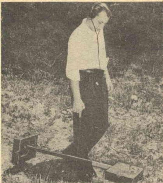
Una versione del cercametalli a trasmettitore e ricevitore
