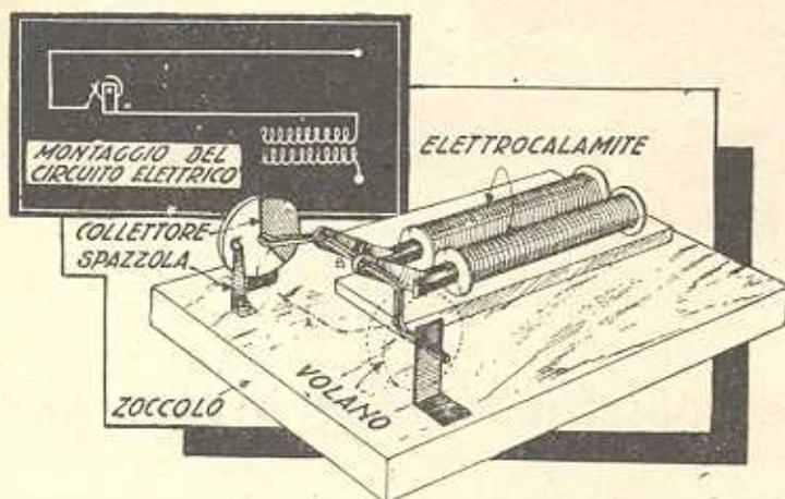
Questo motorino elettrico funziona con corrente continua ed alternata da 10 a 12 volts. Le sue parti fondamentali sono date da due bobine di elettrocalamita, ottenute avvolgendo circa 700 spire di filo isolato di 4/10 su carcasse metalliche.
