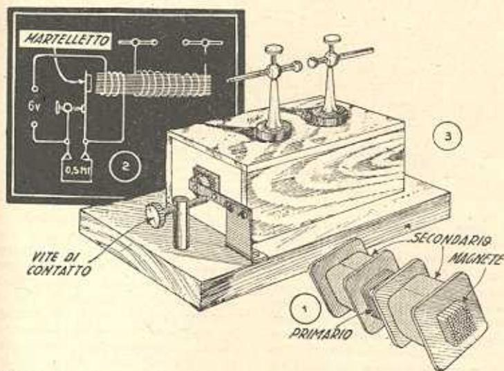
È noto quante esperienze elettriche assai divertenti, e non divertenti soltanto, possano farsi con un rocchetto di Ruhmkorff. Ma un apparecchio del genere costa assai caro, a doverlo acquistare nei negozi, ed ecco che abbiamo pensato ad insegnare ai nostri lettori come fabbricarsene uno con vecchi pezzi di radio fuori uso, e particolarmente con due trasformatori di rapporto 1-3.
