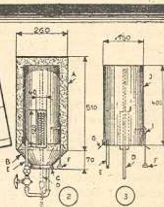
un foro laterale per il passaggio del tubo di rame contenente il termostato I (figura 3 e dettaglio fig. 4), ed esser munito di tre grafie G, che verranno saldate alla sua estremità inferiore. Tali grappe faranno presa sul bordo interno dello scaldabagno, e saranno tenute in sito da gocce di saldatura (vedi figura 2).
