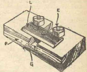
Lo strumento si compone di una tavoletta di legno duro p, solcata da una profonda scanalatura centrale g, al di sopra della quale la lama l (comunemente una lametta da tempera-matite) è tenuta ferma dai controdadi di due viti che, infisse nella faccia opposta della tavoletta, sporgono da questa di quel tanto che basta ad avvitare i controdadi in questione.
