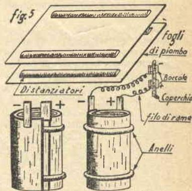
Prendere un foglio di piombo dello spessore di un millimetro; dividerlo in due nel verso più lungo. Fra i due fogli ricavati interporre due liste di gomma spesse un centimetro e lunghe quanto il foglio, altre due liste porle sopra, parallelamente alle altre due (fig. 5).
