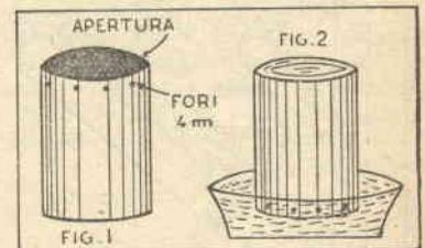
Provvedetevi di una scatola di latta, ed asportatene completamente uno dei coperchi.
