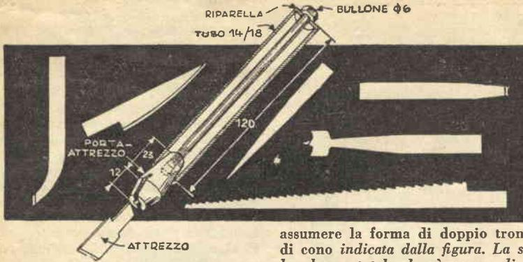
Una serie di lame e di utensili vari, un tubo ed un'asta filettata permetteranno di realizzare senza difficoltà questo strumento, utilissimo per la lavorazione del legno, del cuoio, delle sostanze plastiche, etc.
