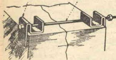
Robuste morsette per pezzi grossi che eccedono la capacità dei morsetti a C possono essere fatti nel modo seguente: si prendono due pezzi di reggetta e si piegano come indicato, praticando dei fori per la chiave. Un notevole campo di regolazione si può ottenere tagliando una lunga filettatura sulla chiave.
