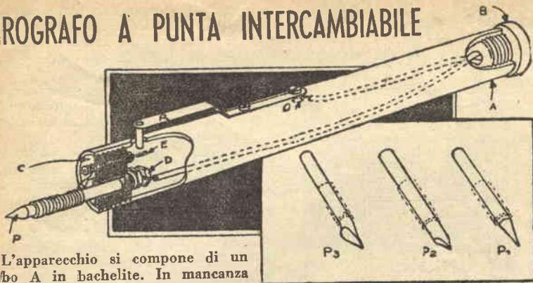
L'apparecchio si compone di un tubo A in bachelite. In mancanza di questo può essere adoperato un tubo di cartone formato avvolgendo intorno ad un'anima di legno un foglio di cartoncino imbevuto di silicato di sodio (che verrà lasciato asciugare per ventiquattro ore). Questo tubo dovrà avere uno spessore minimo di mm. 2, al fine di poter essere filettato alle due estremità.
