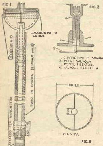
to questo, saldandolo a stagno nel centro dell'attacco (che deve essere di ottone) e tenendolo a posto con un pontefissatore (come da disegno).
