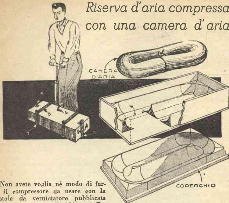
Non avete voglia nè modo di farvi il compressore da usare con la pistola da verniciatore pubblicata sul nostro numero di febbraio? Eccoli allora una semplice maniera per costruirvi un serbatoio di aria compressa, capace di resistere a pressioni abbastanza elevate.
