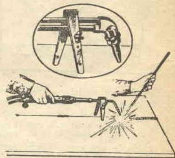
Un bilanciere per il cannello a mano da usare quando si saldano lunghi cordoni, si costruisce facilmente con una cerniera. Fissate la cerniera al cannello con una vite e un dado ad alette. La cerniera allargata serve a sostenere il cannello.
