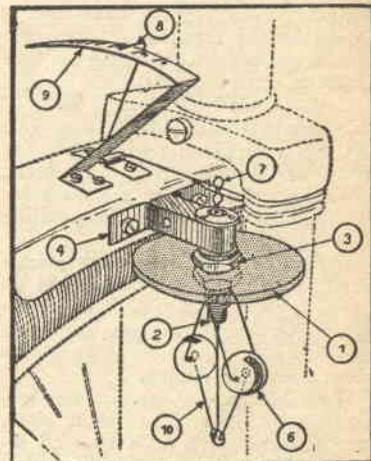
tenuta ferma tra le due piegature in un collarino fissato sul parafrangente — la cui estremità (8) si sposta su di un settore (9) graduato, permettendo così la lettura della velocità.
