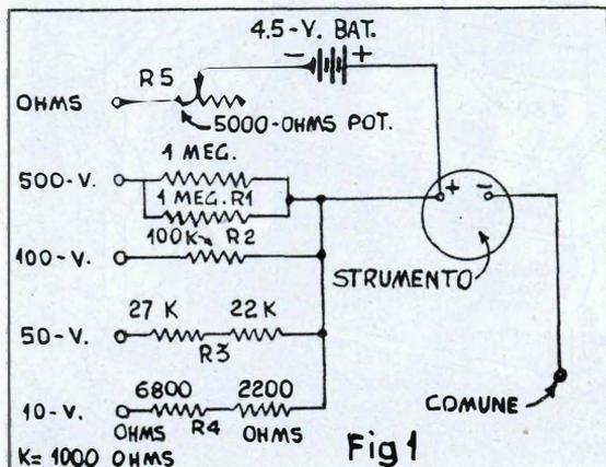
Sono previste quattro portate di tensione continua, cosicché lo strumento può permettere agevolmente letture tra 0 e 500 volts. Queste portate sono divise in modo da fornire letture da 0-10, 0-50, 0-100 e 0-500 volts.
