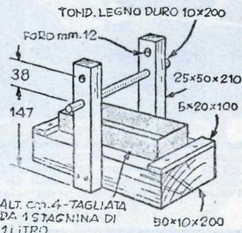
I catrame e la resina accumulati ai lati dei denti delle seghe circolari, ne riducono fortemente l'efficienza, cosicché è conveniente costruirsi un supporto che permetta di pulirle rapidamente ogni volta che se ne ravvisa la necessità, senza ricorrere ai normali sistemi, i quali, generando una certa quantità di calore, finiscono per rovinare la tempera della lama.
