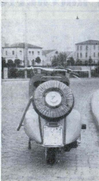
Si compone di un solo tratto di tubo per mobili, in ferro, del diametro di 22 cm.. Per la esecuzione delle curve è raccomandabile rivolgersi a un tubista, di quelli che fabbricano seggiole in metallo cromato, presso il quale si troverà certamente ampia scelta di tubi. I punti d'appoggio sono tre: due costituiti dai perni di sospensione del motore, e il terzo costituito dai fori previsti sul portapacchi posteriore per l'applicazione del supporto da ruota di scorta.
