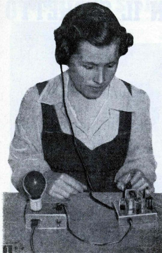
*Questa compatta unità fornisce voltaggi continui per azionare radio, amplificatori e tutti i tipi di apparati elettrici sperimentali.*
