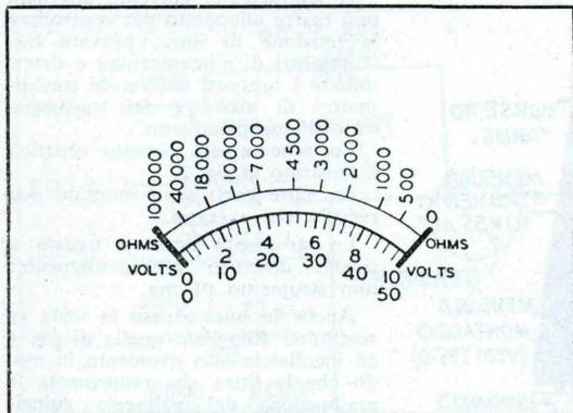
Fig. 3 - La scala del volt-ohmetro per tensioni continue
