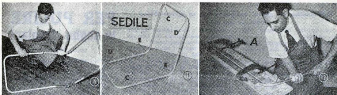
Una volta preparate due sezioni uguali, le si uniscono inserendo nelle loro estremità tondini di legno spalmati di cemento (foto 10), ottenendo così l'intelaiatura del sedile mostrata in foto 11. Si passerà quindi all'esecuzione delle gambe, cominciando con l'eseguire
