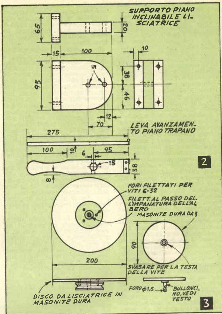
il piano di lavoro del trapanetto e dovete modificare la posizione del supporto. Quando vi capiterà di eseguire la centratura del disco relativo al trapanetto, ponete la massima cura affinché il centro di esso risulti con esattezza dinanzi alla punta del trapano e che questa ultima sia rigorosamente perpendicolare rispetto al primo.
