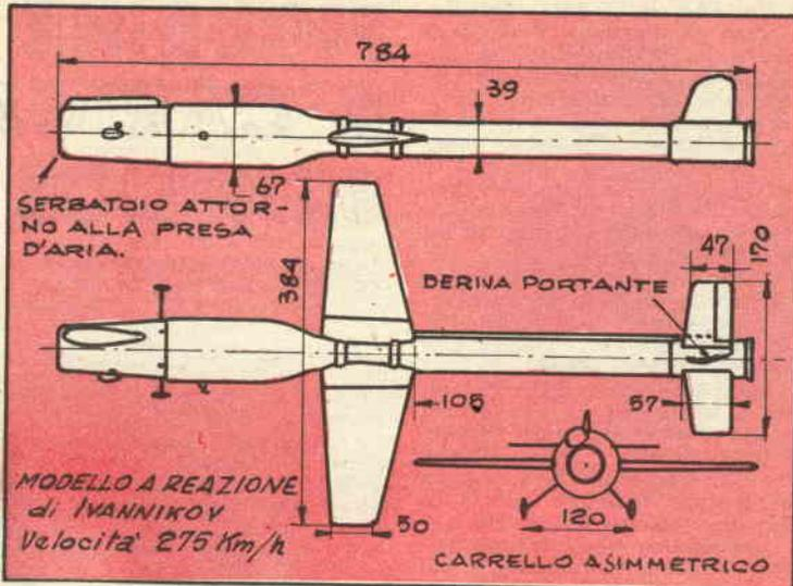
verso dimensioni notevolmente grandi in quanto, avendo il motore un ingombro frontale di circa 65 mm. di diametro, si sarà portati, per mantenere una sufficiente distanza tra la struttura ed il reattore, a dimensioni di circa il doppio e fino a 150 mm.
