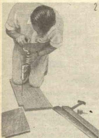
Nel taglio appositamente fatto nella parte inferiore delle pareti laterali si inchiodano le estremità dell'elemento frontale di base (cm. 120 x 7,5). Questo, naturalmente deve essere disposto in modo che non sporga oltre le facce esterne delle pareti laterali stesse. L'unione di tutte le parti del mobile, ad eccezione del pannello posteriore si eseguono con chiodi da 50 mm. bene appuntiti.
