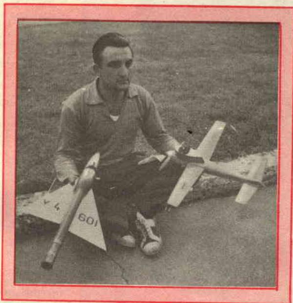
Il napoletano Podda, ora a Genova, mostra i suoi due ultimi modelli da velocità: quello a destra con motori alternativi, quello a sinistra con pulsoreattore ad ala a delta.
