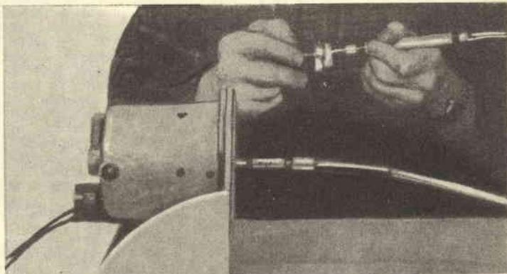
Liberto degli accessori, l'asse del motore può ricevere l'adattatore di un albero flessibile, che permette l'esecuzione di lavori in qualsiasi punto anche difficilmente raggiungibile. Ottima disposizione per l'uso di seghette circolari, di rotelle abrasive, di spazzoline rotanti, di punte per trapano ad alta velocità, ecc.
