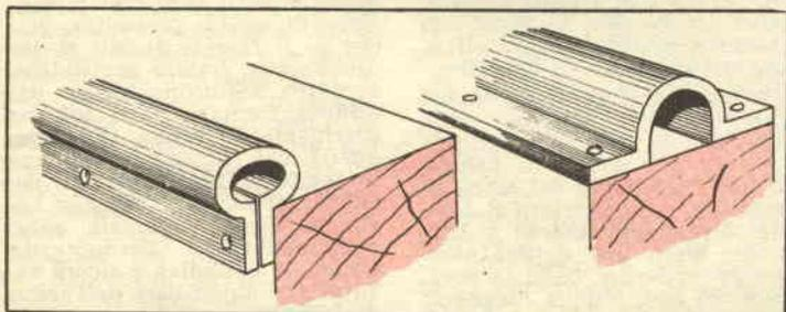
Due esempi tipici della utilizzazione del profilato di plastica ad «U», illustrato dalla foto precedente. Nel primo caso, serve per bordare i tre lati della porta, mentre nella seconda maniera si usa per bordare il lato inferiore della porta stessa, senza che sia necessario smontare la porta dal suo supporto.
