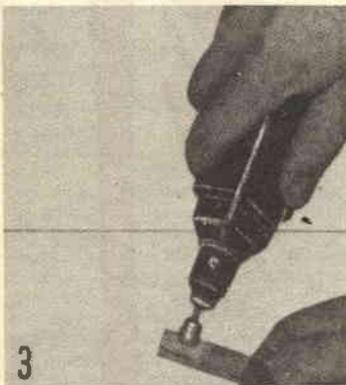
La seconda fase consiste nello spulire leggermente la superficie da saldare e nel passarvi sopra la rotella abrasiva caricata di lega; in modo che parte di questa ultima fonda e vada ad aderire alla superficie; con un'unghia si senta se lo straterello depositato sia tenace.
