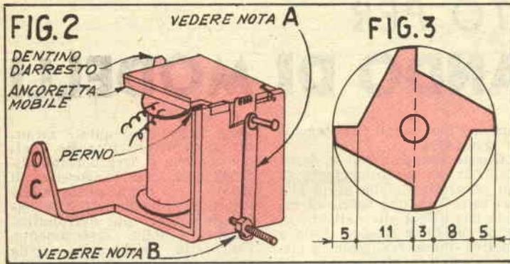
NOTA A - Vite da mm. 2,5 che serve per la regolazione della corsa della ancoretta sotto un dadino è serrata una molletta di acciaio di richiamo, ricavata da una vecchia molla da sveglia (mm. 7 x 26).
