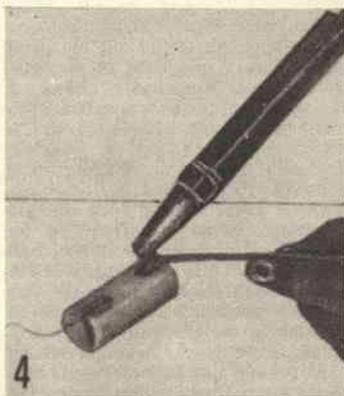
Successivamente si applica con un saldatoio, sulla zona preparata, dell'altra lega di stagno e piombo e con questa si effettua poi la unione con l'oggetto metallico che si intende saldare.
