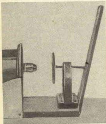
In questa foto l'utensile è pronto per funzionare come trapanetto orizzontale a colonna; come si vede, la leva serve per l'avanzamento del piano circolare su cui vengono posate e tenute le parti da forare.
