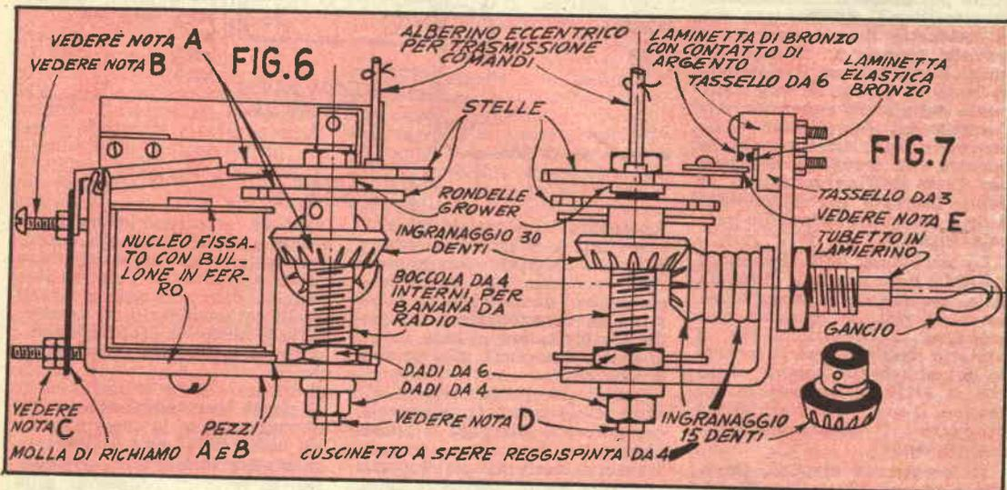
NOTA A - Filettare internamente a passo 4/75, il pignone più grande per poterlo bloccare sull'asse in acciaio da 4 mm. su cui sono fissate anche le stelle. Se sul pignone vi è una vite di bloccaggio, la filettatura è superflua.
