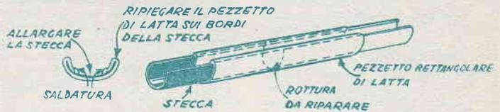
Saldatura del profilato realizzato con la latta, allo scopo di riparare una stecca rotta, che per il momento non possa essere sostituita.
