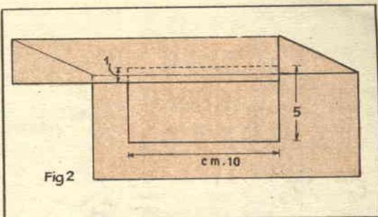
fig. 2) delle dimensioni di cm 10 x 5 e dello spessore di mm. 2, servendosi di una coppia di viti con dado.
