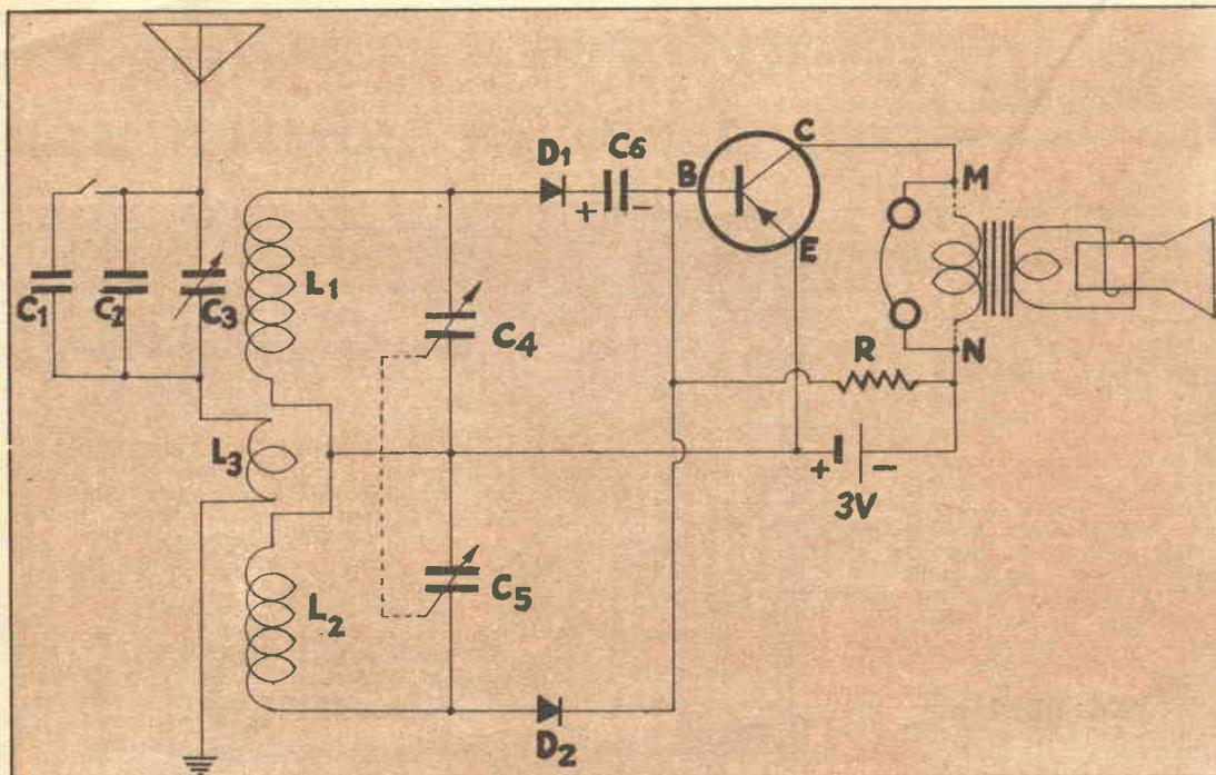
del tipo speciale per batteria. Ho fatto diverse prove alla ricerca del trasformatore di uscita che meglio si prestasse a funzionare in questo circuito e dopo avere provato molti tipi di trasformatore da apparecchi a valvole, ho ripiegato sul trasformatore U/3, il quale oltre che ottime prestazioni, ha anche un prezzo assai basso.
