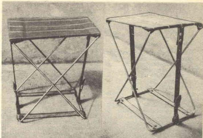
incontrano: ho infatti notato come questo perno, non sia affidi unione tra le estremità ripiegate, è raccomandabile seguire una saldatura, possibilmente ossiacetilenica, in modo da avere i due telai della massima solidità possibile. Nel punto in cui le varie cinghie debbono formare occhiello per per-
