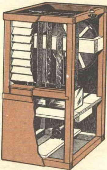
Un tubetto di gomma o di plastica collegato al rubinetto che si può vedere sul lato destro dell'apparecchio permette l'afflusso della acqua potabile alle strisce dell'evaporatore. Nel caso che non si voglia fare uso di un tubetto collegato con l'impianto idrico, si installerà, in prossimità del rubinetto, in alto, una lattina della capacità di diversi litri
