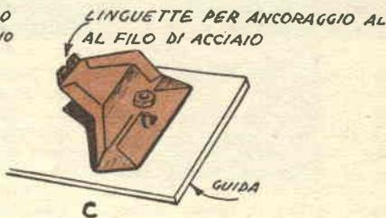
Modellino in carta, che va incollato sulla latta in modo da fare due esemplari uguali, di questo pezzo. B = piegatura di parte della latta lungo i bordi allo scopo di aumentare la resistenza della guida. C = guida completata al momento del suo fissaggio alla squadra. Notare il bullone con dado e soprattutto il foro oblungo per la regolazione.
