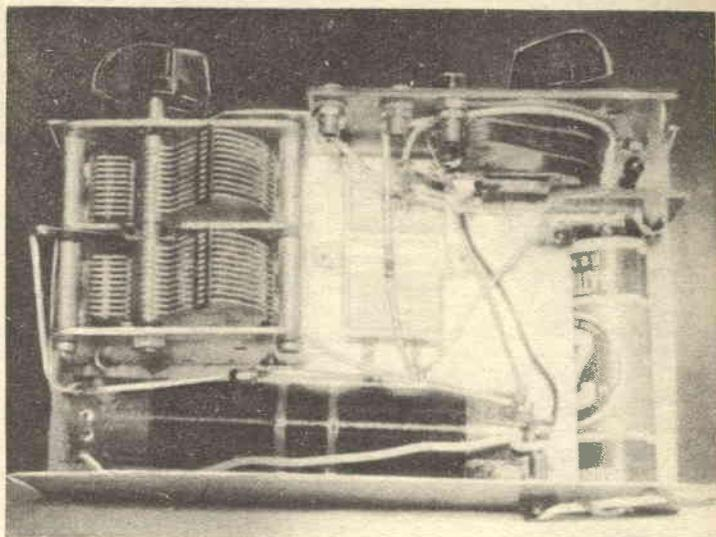
Il circuito di alta frequenza non differisce sostanzialmente da quello pubblicato sul numero 6 dell'annata '53 della Rivista e relativo appunto ad un ricevitore a due diodi; eccezion fatta per l'impiego di due condensatori in ceramica C1 e C2, i quali servono a rendere possibile una maggiore potenza di uscita ed una maggiore selettività, specie nel caso della presenza, nelle vicinanze, di stazioni trasmettenti locali.
