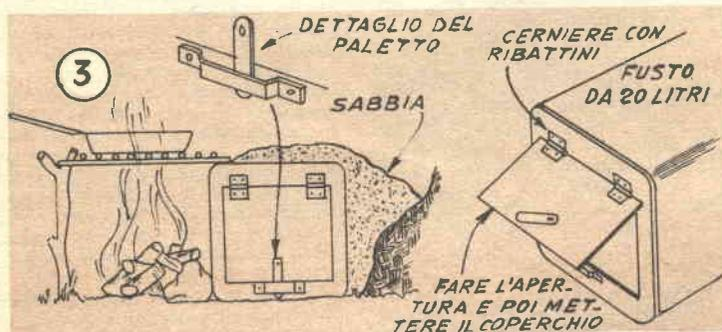
FIG. 4. — Altra utilizzazione di un recipiente da 20 litri, questa volta per realizzare una stufetta per il riscaldamento della tenda. Non sarà da attendere l'inverno per trarre vantaggio, in quanto tutti i campeggiatori sanno come molte delle nottate estive, all'aperto specialmente in zone collinose o di montagna, la temperatura sia molto rigida. Per questo impiego, le lavorazioni sul fustino, sono le seguenti: apertura di un foro, in
