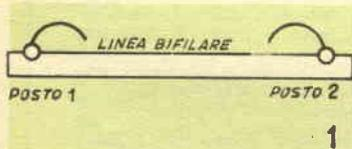
Il più semplice circuito elettrico di apparecchio di comunicazione, in cui viene messa a profitto la reversibilità di un auricolare magnetico, di funzionare oltre che da ricevitore, anche come trasmettitore
