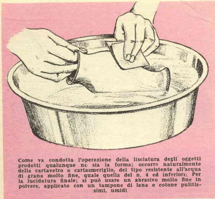
Come va condotta l'operazione della lisciatura degli oggetti prodotti qualunque ne sia la forma; occorre naturalmente della cartavetro o cartameriglio, del tipo resistente all'acqua di grana molto fine, quale quella del n. 4 ed inferiore. Per la lucidatura finale; si può usare un abrasivo molto fine in polvere, applicato con un tampone di lana o cotone pulitissimi, umidi
