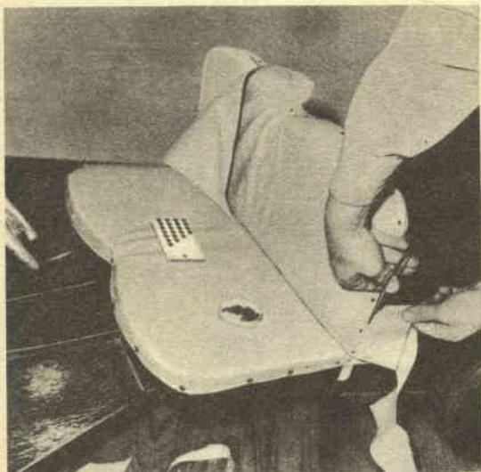
Stenditura della copertura in finta pelle, sulla gomma della imbottitura, ancoraggio dei lembi lungo i bordi superiori dello schienale ed anteriori del sedile, indi taglio del materiale in eccesso, con chiodi uniformemente spazati; eventualmente, una piccola porzione del materiale sarà ripiegata in orlo
