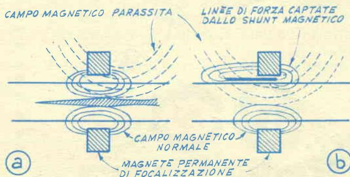
**A), il campo magnetico parassita modificato dal magnete di concentrazione. B), una parte delle linee di forza è intercettata dal frammento di lama, in funzione di shunt magnetico e questo basta spessissimo a correggere l'effetto del campo parassita, tutt'al più, a volte la impresa richiede molte prove**
