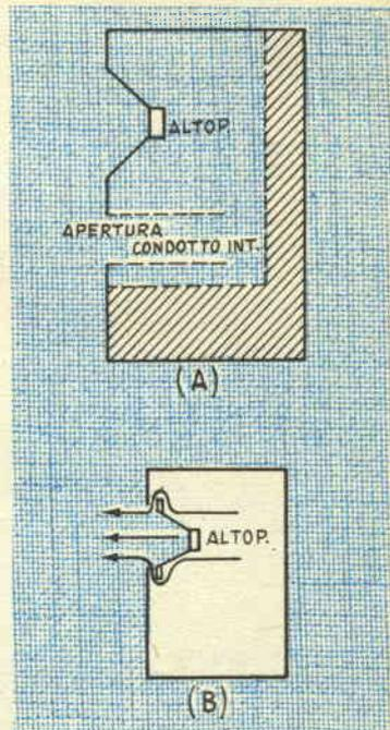
Due sistemi largamente adottati per ridurre nei limiti del possibile le dimensioni di un mobile acustico senza pregiudicarne la risposta sui bassi. A), la zona tratteggiata è quella dello spazio che si può risparmiare in un mobile aggiungendolo ad esso, il condotto interno, illustrato in basso. B), l'altoparlante è fissato con la bocca leggermente arretrata rispetto al pannello frontale; le onde di pressione posteriore fuoriescono da una apertura appositamente conformata
