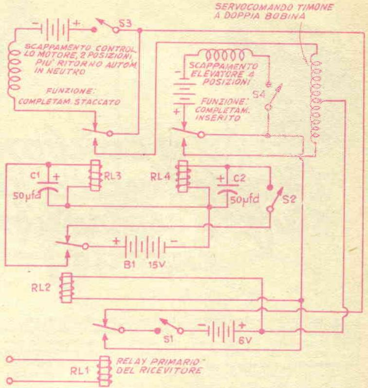
Disposizione schematica della aggiunta da fare al complesso elettromeccanico comandato dal ricevitore del radiocomando. Tutti gli interruttori, in questo schema appaiono aperti, ma vanno chiusi quando il complesso è in funzione, pena il bloccaggio di qualcuna delle sezioni: il circuito vale; nel caso di ricevitore con diseccitazione di relay in presenza di segnale; nel caso di ricevitore con diseccitazione di relay in presenza di segnale, invertire le connessioni.
