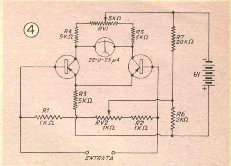
Microammperometro a transistor con stabilizzazione ottenuta mediante un circuito di amplificazione in CC, di tipo simmetrico e bilanciato.
