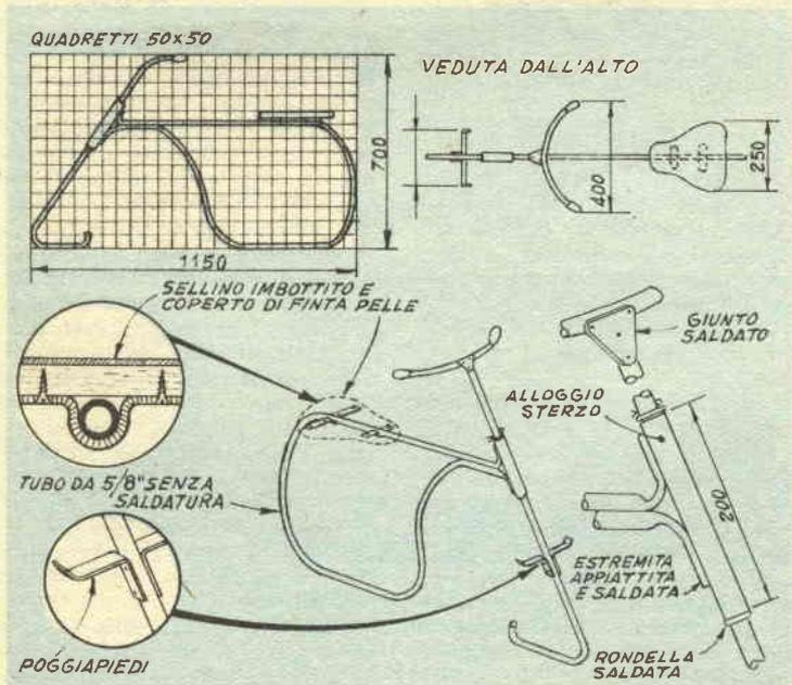
bili e suppellettili in tubolare metallico. In particolare per quello che riguarda il materiale che nel nostro caso deve essere usato, ossia il tubo di acciaio inossidabile segnaliamo che la sua piegatura, effettuata per stadi successivi, si esegue assai facilmente dopo aver reso alquanto cedevole il metallo nella zona da piegare dirigendo su di esso, la fiamma di una fiaccola a benzina o di una torcia a gas.
