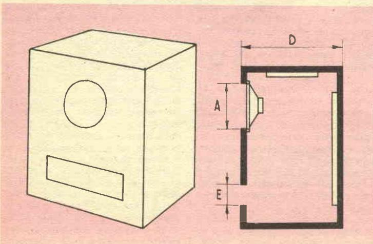
Dettagli costruttivi per mobili *bass reflex* di diversa grandezza adatti ciascuno per un altoparlante di particolare diametro; tutto il legno deve essere paniforte da 20 mm, tutti i giunti vanno incollati ed avvitati, tre pareti interne non parallele, debbono essere ricoperte di materiale fonoassorbente, quale il moltoplen soffice dello spessore di 20 mm.
