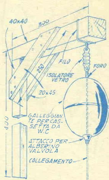
di queste, la estremità che si trova vicina come si è visto, alla estremità inferiore della antenna deve essere collegata alla linea simmetrica o no, che porta il segnale dal trasmettitore od al ricevitore, a seconda che la antenna stessa viene usata in trasmissione od in ricezione.
