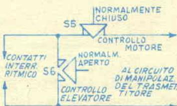
Disposizione da adottare nel complesso di manovra del trasmettitore; S5 ed S6 possono essere del tipo a contatto temporaneo a pulsante, il primo a circuito di riposo normalmente chiuso, il secondo con circuito di riposo normalmente aperto
