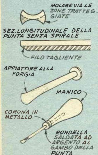
Un metodo abbastanza sbrigativo, è quello di squadrare la punta del trapanetto, molarne un lato della scanalatura alla estremità in modo da lasciare solamente l'altra che formi una sezione a C e quindi di molarne con la ruota più fina, il bordo in modo da creare di nuovo il profilo voluto. Un altro sistema è quello di riscaldare al calor rosso le punte sulla fiamma del gas, o meglio ancora su di un calore uniforme quale è quello del carbone nella stufa, indi lasciarlo
