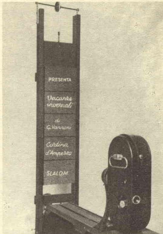
Titoli e brevi diciture montate su questo dispositivo scorrono lentamente sul piano focale della cinepresa; il meccanismo è facilmente realizzabile e si presta anche a numerose variazioni a seconda delle differenze di effetti che si vogliono ottenere; una certa elevazione della cinepresa permette di disporre, nella parte bassa del dispositivo, di un certo spazio che possa contenere altri rettangoli o pannelli.
