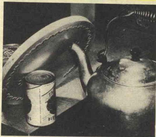
La vaporizzazione del legname fa risaltare le fibre del legno nelle zone che erano state compresse e quindi le fa apparire in rilievo, ripetendo fedelmente tutti i particolari che erano stati prodotti nella punzonatura.
