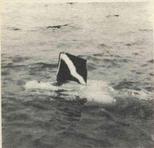
Una bendierina munita di ventosa può essere applicata alla parte superiore dello scooter in modo che quando questo giunge in superficie, prima che vi arrivi il subacqueo, il quale deve sottostare ad un breve periodo di decompressione, avverte le imbarcazioni specialmente a motore presenti nella zona, della presenza del nuotatore, in modo che queste possano procedere con la dovuta precauzione.
