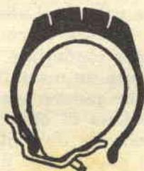
3) Si spinge il fungo della valvola in modo che possa entrare nel pozzetto che si trova al centro del cerchione.
