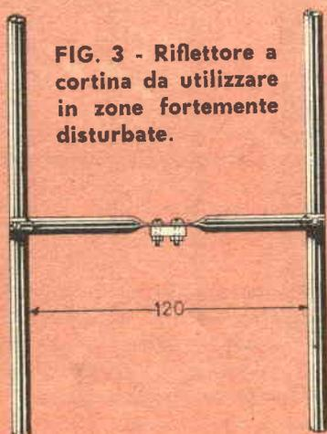
FIG. 3 - Riflettore a cortina da utilizzare in zone fortemente disturbate.
