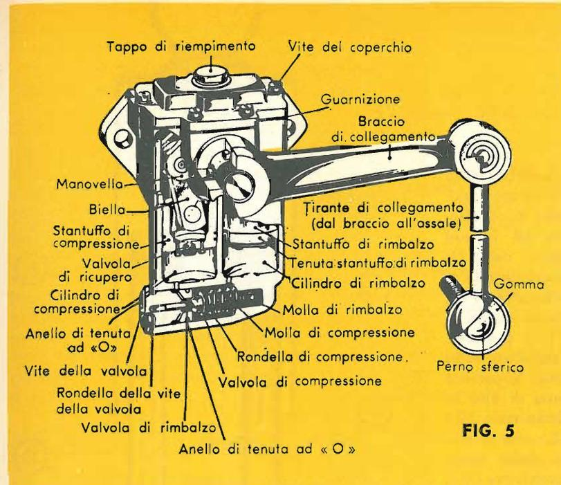
**FIG. 5 - AMMORTIZZATORE DEL TIPO A «LEVA».** Un tipico ammortizzatore idraulico a leva a doppio effetto.
