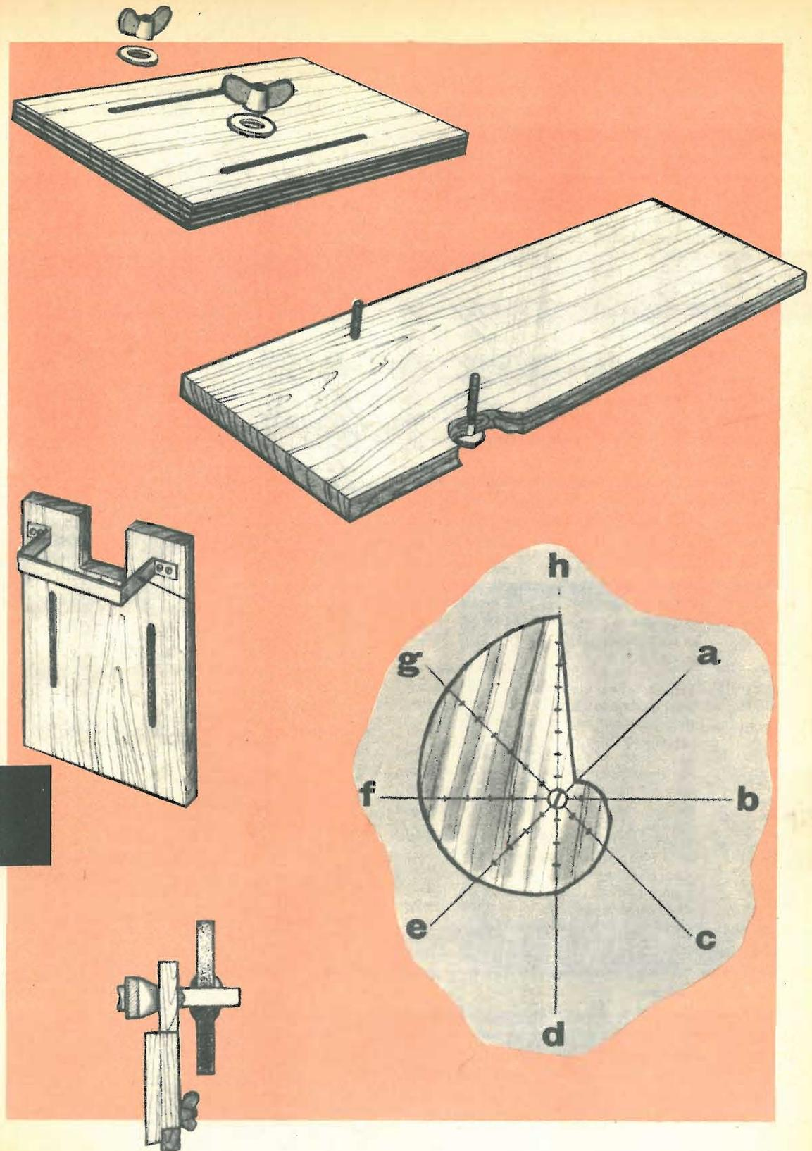
di a galletto, essi serviranno a tenere fissata in posizione la slitta di fig. 3, alla quale è affidato il compito di sostenere il trapano e di spostarlo in avanti ed indietro in modo di avanzare la punta, o arnese di taglio sul lavoro. Per fissare come detto precedentemente il trapano, dovremo preparare un castelletto a forma di culla, con dimensioni adatte a sostenerlo rigidamente.
