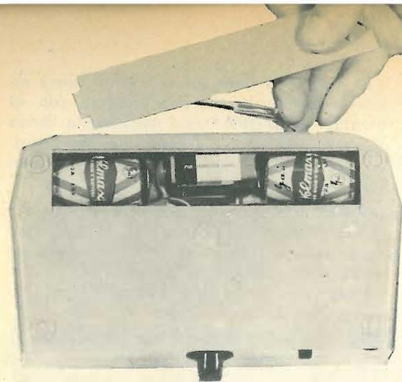
FIG. 5 - Le pile si possono facilmente togliere, dal nostro registratore, senza doverlo smontare, dalla comoda finestra posta posteriormente, come vedesi nelle foto. Un coperchio, poi, chiude la finestra in modo perfetto.
