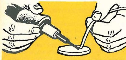
Stagnare la parte argentata e il fermaglio di metallo col saldatore, usando fondente di resina
