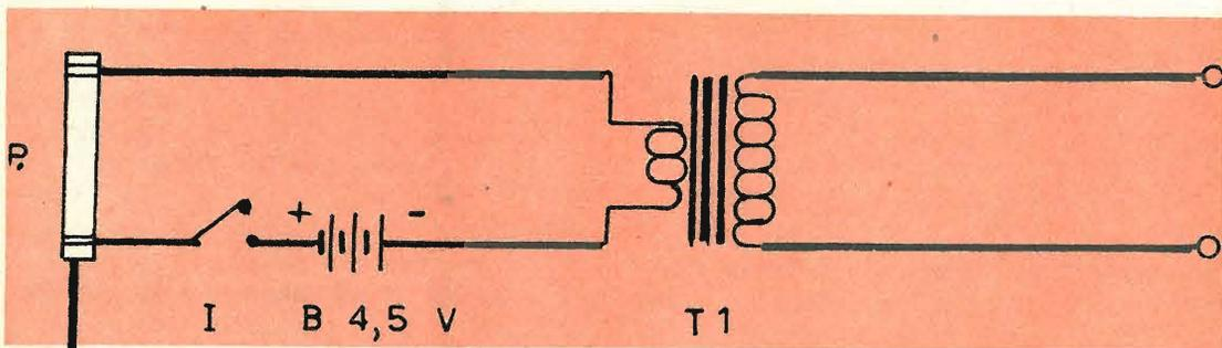
Mediante l'impiego di una sonda microfonica, invece, il rumore può essere circoscritto e individuato sul nascere e, con l'impiego di punte ricurve, può essere ricercato anche là dove normalmente sarebbe difficile giungere. Ma anche per la ricerca di tubature di acqua corrente nelle pareti o per l'individuazione di cavità nascoste e per svariare altre applicazioni la sonda può essere di grande utilità.
