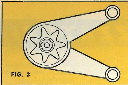
**FIG. 3 - AMMORTIZZATORE DEL TIPO «AD ATTRITO».** Ammortizzatore ad attrito di tipo antiquato. Questo consisteva semplicemente in due dischi ricoperti con materiale di attrito montati su di un asse comune e liberi di ruotare. L'azione di una molla manteneva in contatto le superfici dei due dischi, e questi ultimi erano collegati mediante leve, uno all'assale della ruota e l'altro allo chassis.
