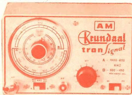
a transistor, uno strumento semplice, economico, veloce, sia per la taratura che per la ricerca dei guasti. Quindi il ns. Giudizio è ottimo, ma non potremo terminare questa nostra prova senza spiegare come si effettua la taratura in un apparecchio a transistor, oppure come si deve condurre una ricerca per localizzare i guasti, utilizzando il transignal.
