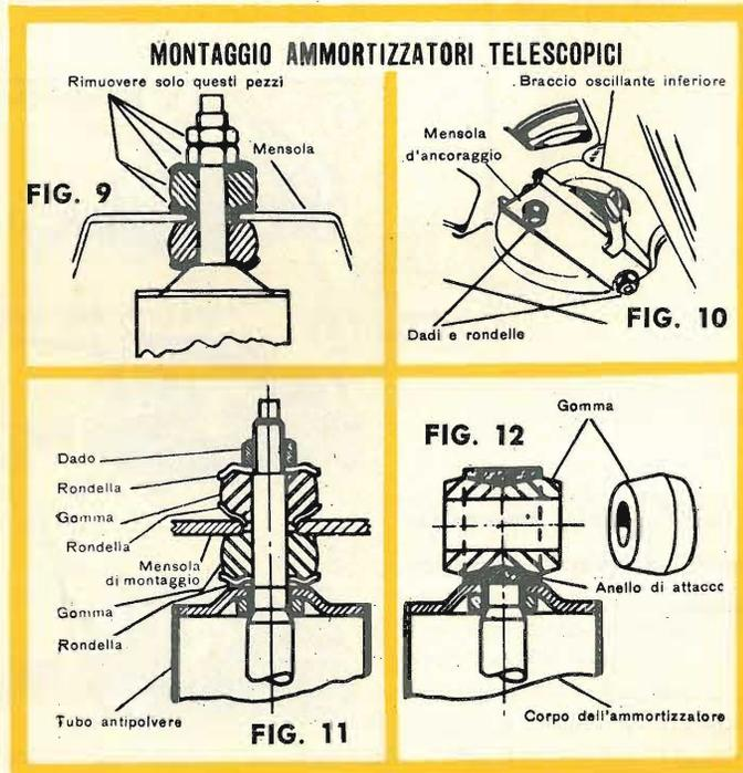
FIG. 9 - Montaggio del perno superiore della sospensione anteriore.
