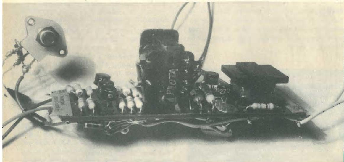
FIG. 4 - Realizzazione sperimentale dell'amplificatore per l'interfonico. Le dimensioni sono sufficientemente ridotte perché esso trovi posto nella custodia dell'altoparlante principale od in altro alloggiamento. Vi sono alcune differenze rispetto allo schema definitivo di fig. 3, dalla disposizione più razionale.
