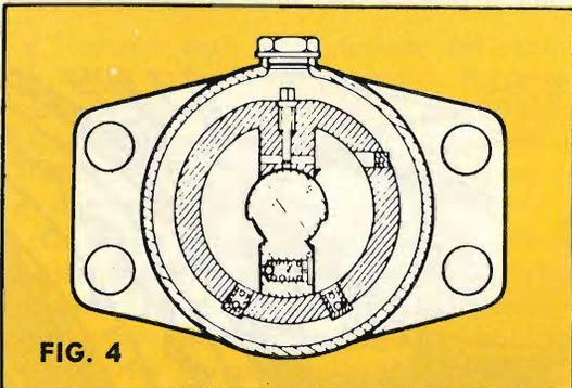
**FIG. 4 - AMMORTIZZATORE DEL TIPO «A PALETTE».** Il suo principio di funzionamento consiste nello smorzare — attraverso un adatto collegamento — il movimento della molla facendo passare l'olio attraverso un foro di piccole dimensioni praticato nella paletta rotante. La sezione del foro di passaggio del liquido poteva essere variata per mezzo di una vite di regolazione. In questo modo si migliorò l'azione della sospensione, ma non si ottenne ancora una adeguata comodità di guida.
