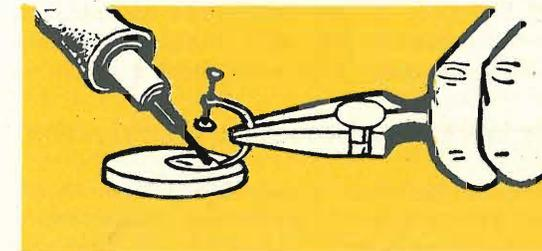
Tenere il fermaglio con le pinze, applicare il saldatore e fondere la lega saldandoli insieme
