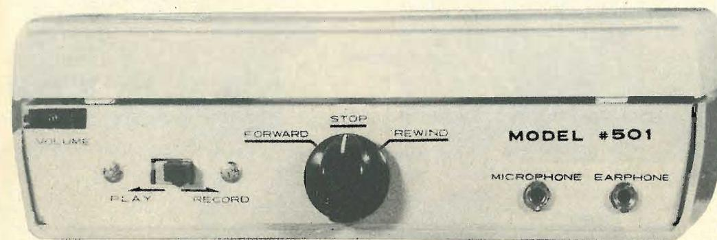
**FIG. 4 - Il registratore chiuso, visto di fronte. Si noti come risultano semplici e comodi i comandi. La manopola centrale comanda, oltre al movimento del motorino, anche la tensione dell'amplificatore a transistor.**
