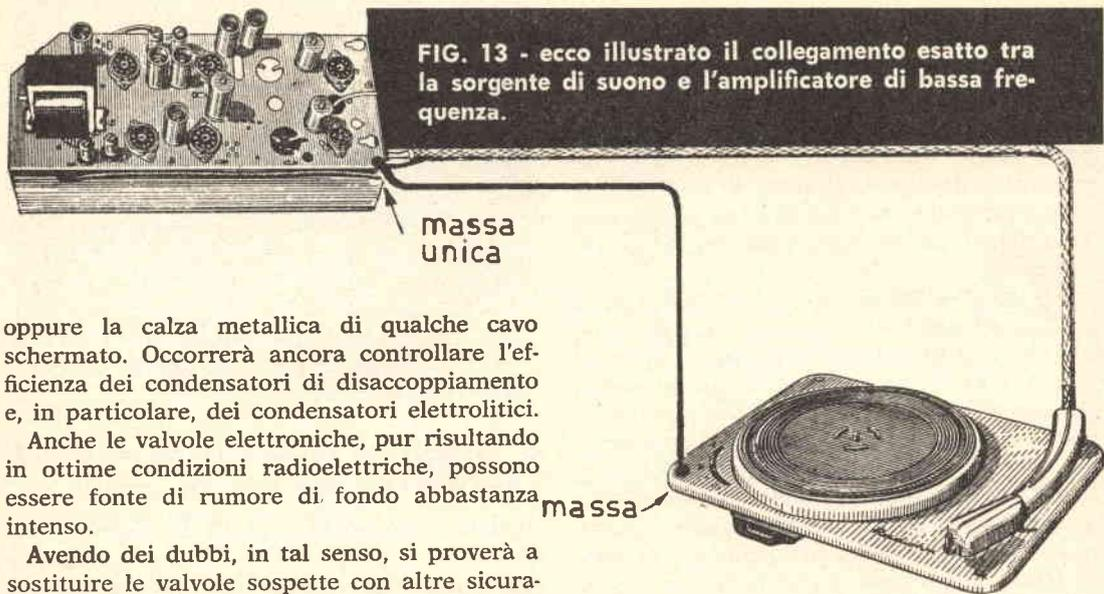
**FIG. 13 - ecco illustrato il collegamento esatto tra la sorgente di suono e l'amplificatore di bassa frequenza.**
