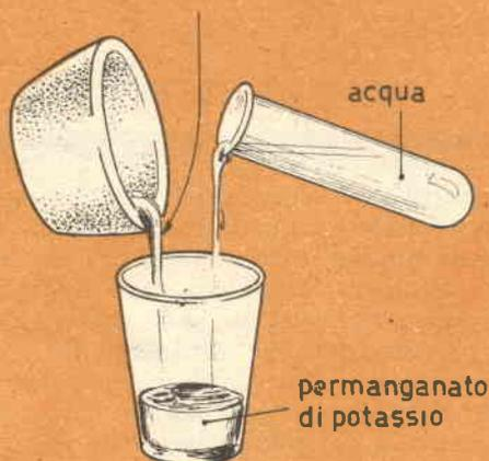
**Preparazione del permanganato.** Si riscalda del biossido di manganese con della potassa caustica finché entrambi i composti non si fondono insieme; quindi, una volta raffreddato tutto, si scioglierà la massa in acqua, ottenendo così una soluzione di permanganato di potassio.
