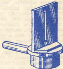
Fig. 7 - Il mirino viene completato con questo oculare. Entrambi i componenti il mirino, verranno poscia stagnati su due coperchi, i quali chiudono superiormente il tubo di vetro.
