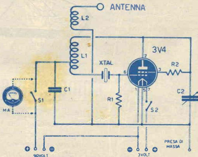
Fig. 1. — COMPONENTI DEL TRASMETTITORE: R1, Resistenza da 0,5 megaohm - R2, Resistenza da 3000 ohm - C1, condensatore a mica da 500 pF - C2 compensatore ad aria da 30 PF - S1, interruttore o pulsante per radiocomando - S2, interruttore per accensione filamento - L1-L2, bobina di accordo (vedi articolo) - XTAL, cristallodi quarzo per 27MHZ.
