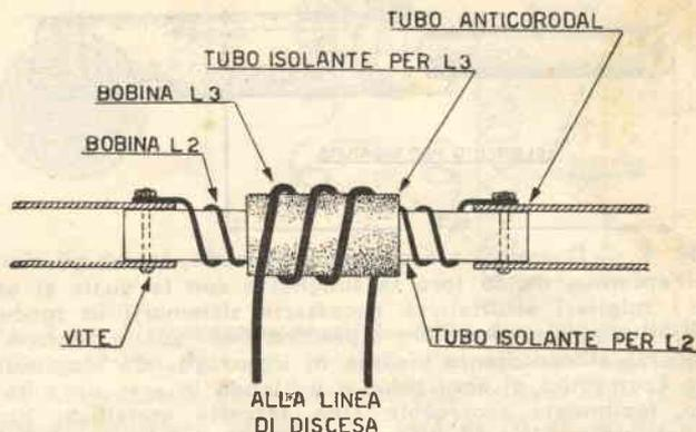
Fig. 3. — Come si effettua l'accoppiamento delle bobine L2 ed L3: il tubo isolante che funge da sostegno alla bobina L2 è infilato entro i tubi laterali che costituiscono l'elemento d'antenna; su L2 si infila un tubo isolante del diametro di circa cm. 2,5, che fa da sostegno all'avvolgimento della bobina L3. I capi di questa bobina si collegano alla linea di alimentazione, costituita possibilmente da un cavo coassiale da 60 ohm d'impedenza.
