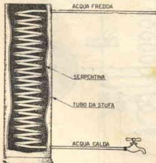
poiché il congegno scaldante è costituito da una serpentina di tubo di rame del diametro interno di circa mm. 9, formata da varie spire. Essa dovrà essere sistemata nell'interno del
