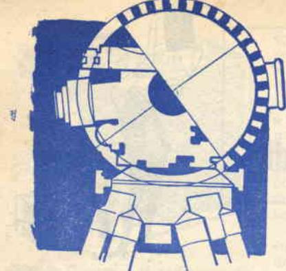
Lo strumento normalmente usato da geometri ed ingegneri per effettuare rilievi è il Teodolite; sarà certamente capitato a tutti, per strada o in cantiere, di vedere una persona curva a guardare in una specie di cannocchiale, sostenuto da un trepiede, mentre una seconda persona fissava in terra, ad una certa distanza, delle aste a righe bianche e rosse.
