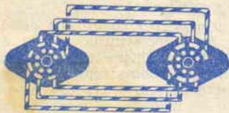
**Fig. 3.** — Per aumentare la potenza si può aggiungere una seconda valvola accoppiandola in parallelo alla prima.
