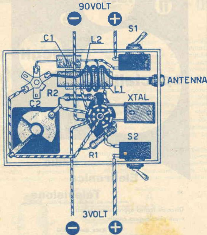
Fig. 2. — Schema pratico del radiocomando descritto nell'articolo.
