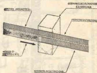
Fig. 4 — Dopo aver registrato per tutta la lunghezza una sola metà del nastro (1<sup>a</sup> traccia) per incidere la seconda metà (2<sup>a</sup> traccia) è sufficiente capovolgere la bobina.
