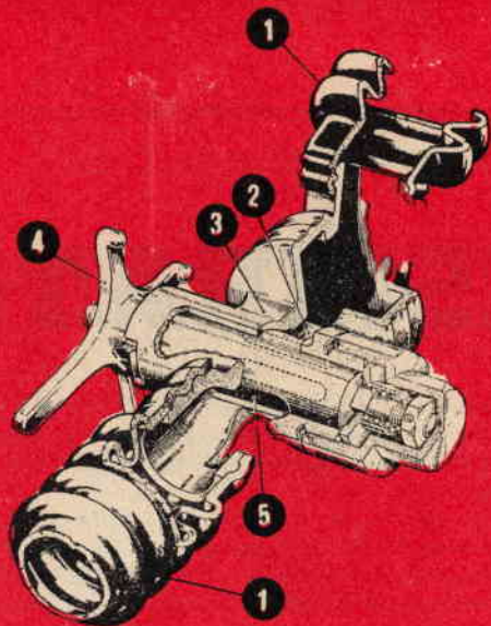
Fig. 3 - Al rubinetto a 3 vie è affidato il compito di comandare il passaggio dalla respirazione atmosferica a quella ad ossigeno. Aprendo il condotto dell'ossigeno contenuto nel sacco polmonare viene a chiudersi automaticamente il condotto dell'aria atmosferica e viceversa.
