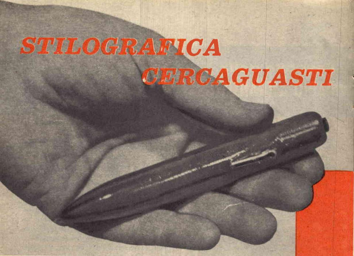
Per la riparazione di apparecchi radio, siano essi a valvole o a transistori, il più delle volte non è necessario possedere ed impiegare strumenti delicati e costosi. Molto spesso è sufficiente una semplice... penna stilografica. Sì, proprio una penna che, in luogo di scrivere, sia in grado di erogare segnali radio ad *alta* e *bassa* frequenza come quella che ora presenteremo.
