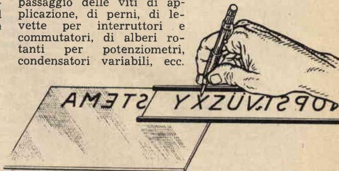
Fig. 2 - Con un normografo adatto scrivete usando inchiostri di china le diciture necessarie, ma alla rovescia.
