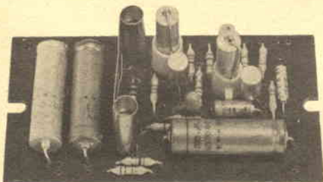
Amplificatore B.F. PMB/A
