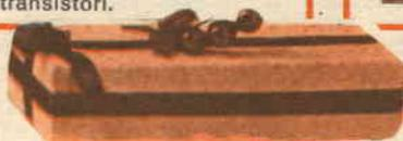
**TRE PANNELLI STAMPATI MINIATURA.** Esecuzione in resina ad altissimo isolamento per l'uso anche in onde corte e VHF. Disposizioni studiate per poter realizzare amplificatori miniatura, preamplificatori e strumenti che saranno in seguito pubblicati.
