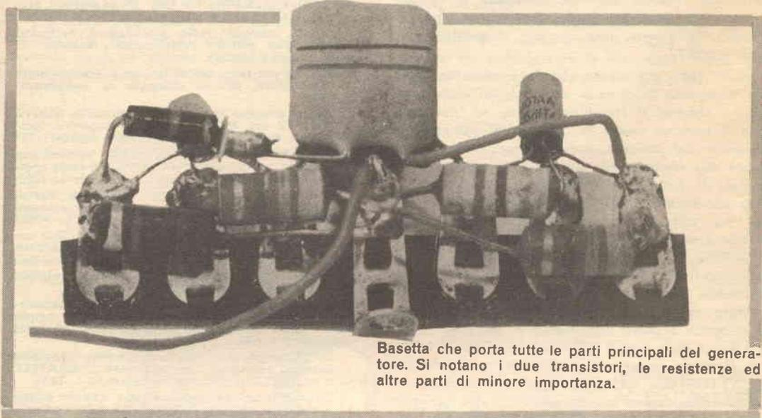
Basetta che porta tutte le parti principali del generatore. Si notano i due transistori, le resistenze ed altre parti di minore importanza.
