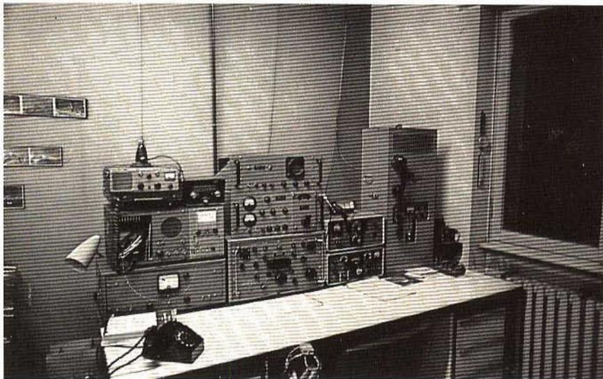
Fig. 6 - Ecco il banco di lavoro in onda ultracorta con cui opera di solito I2BFO. Si notino gli apparati professionali reimpiiegati nella stazione, per la banda dei 144 MHz.
