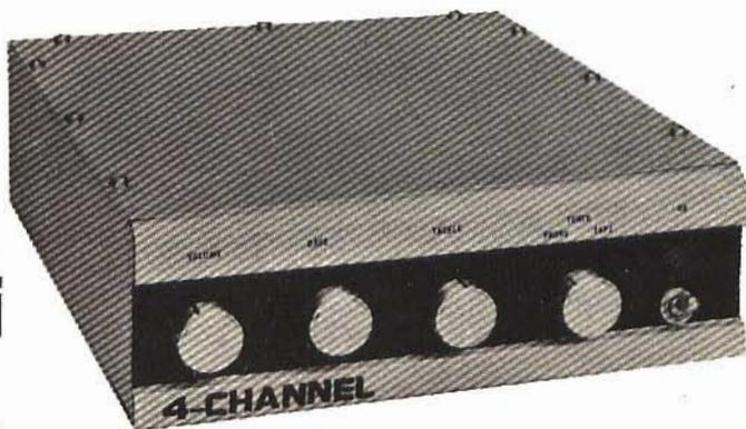
Viene descritto un preamplificatore a quattro canali impiegante due circuiti integrati, dotato di ingressi fono e registratore a nastro, completo di tutti i comandi e realizzato su circuiti stampati con connessioni dirette.
