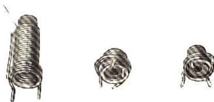
Fig. 7 - Foto illustrante tre tipi di bobine per le diverse gamme.
