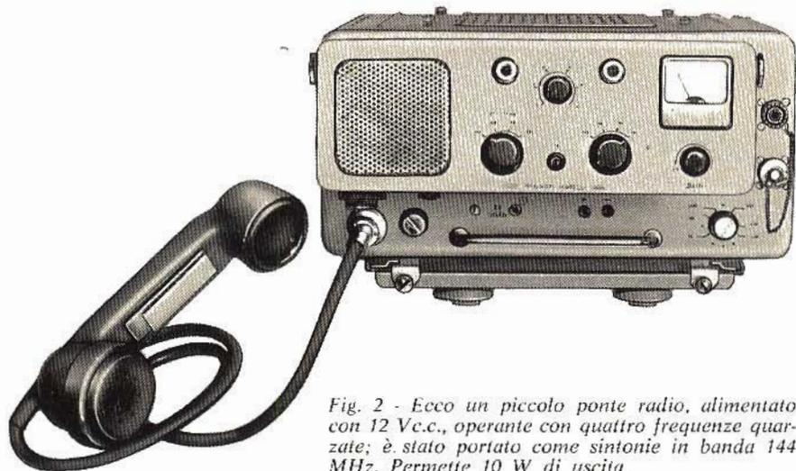
Fig. 2 - Ecco un piccolo ponte radio, alimentato con 12 Vc.c., operante con quattro frequenze quarte; è stato portato come sintonie in banda 144 MHz. Permette 10 W di uscita.
