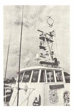
Fig. 4 - Torretta di un guardiacoste U.S.A. attrezzata con un sofisticatissimo radiogoniometro per C.B.
