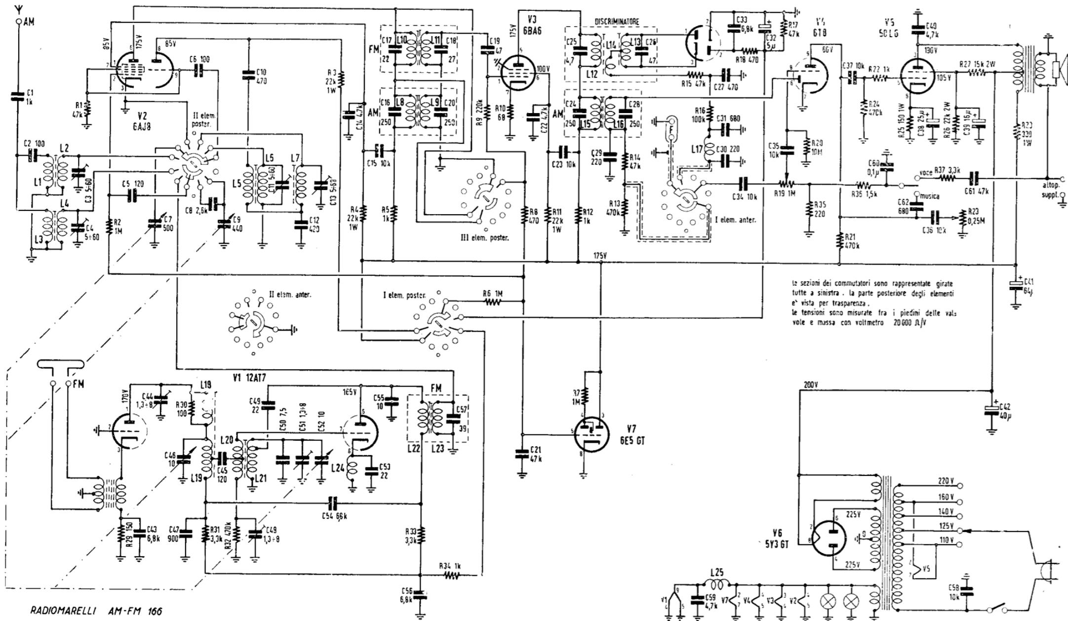
Le sezioni dei commutatori sono rappresentate girate tutte a sinistra. La parte posteriore degli elementi è vista per trasparenza. Le tensioni sono misurate fra i piedini delle valvole e massa con voltmetro 20000 A/V
