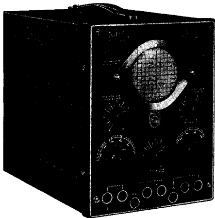
Fig. 1. De nieuwe draagbare Philips Kathodestraal-Oscillograaf GM 3155.
