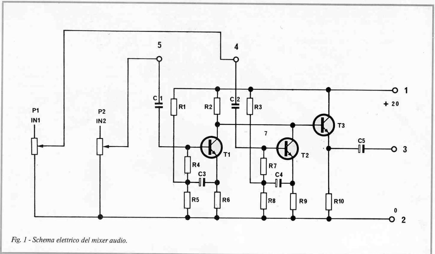
Fig. 1 - Schema elettrico del mixer audio.
