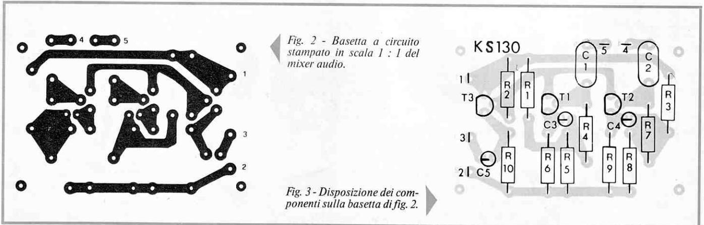
Fig. 2 - Basetta a circuito stampato in scala 1 : 1 del mixer audio.
